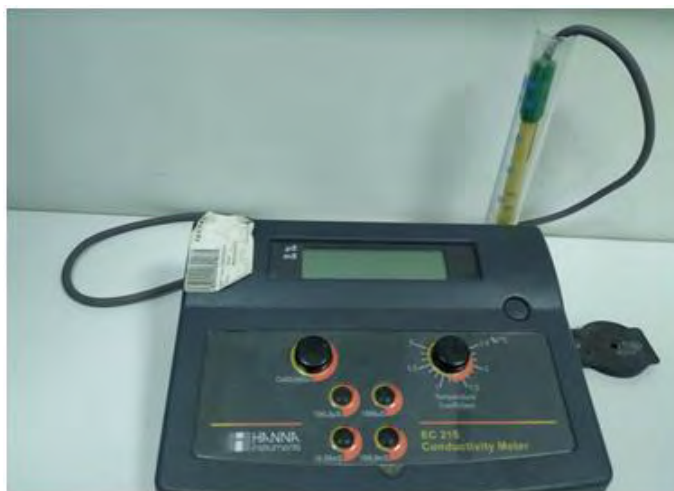
Εικόνα 2. Όργανο μέτρησης ηλεκτρικής αγωγιμότητας, HANNA EC125 Multi-range Conductivity Meter
