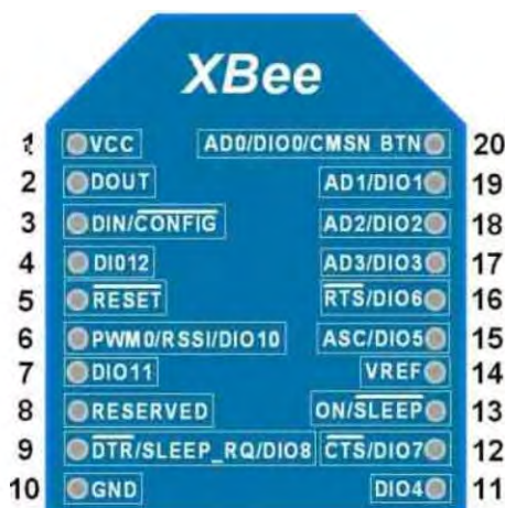
Σχήμα 3.2: Xbee Pinout
