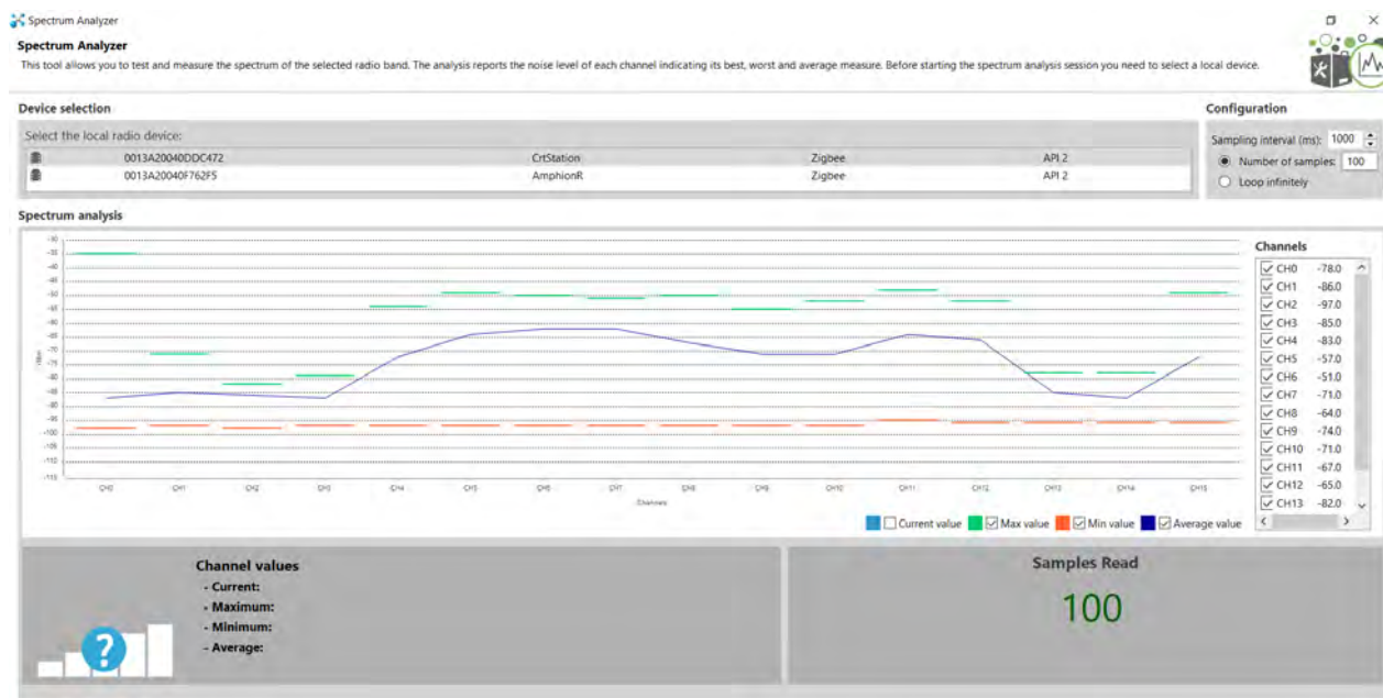
Σχήμα 5.10: Έλεγχος φάσματος στο δέκτη
