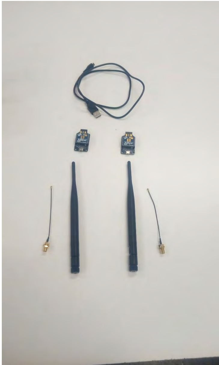
Σχήμα 5.1: Κομμάτια διαμόρφωσης ασύρματης επικοινωνίας: 2 Xbee, 2 Xbee USB adapters, 1 καλώδιο micro-usb
