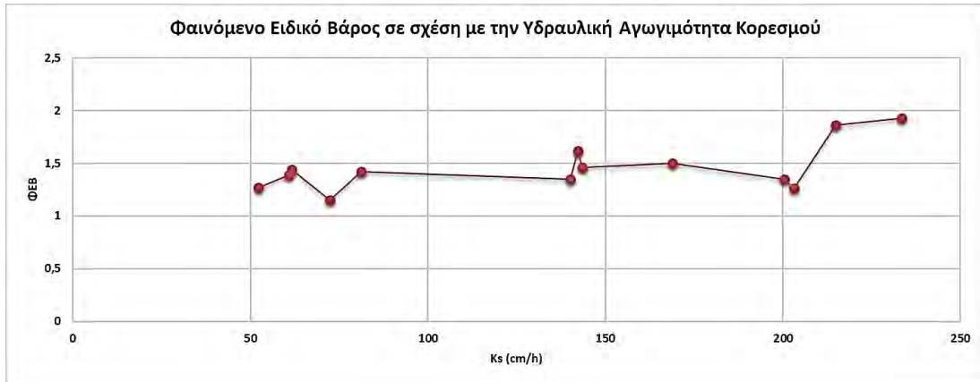
Διάγραμμα 5.1. Διακύμανση του φαινομένου ειδικού βάρους (ΦEB) σε σχέση με την υδραυλική αγωγιμότητα ( K_s ) κορεσμού.
