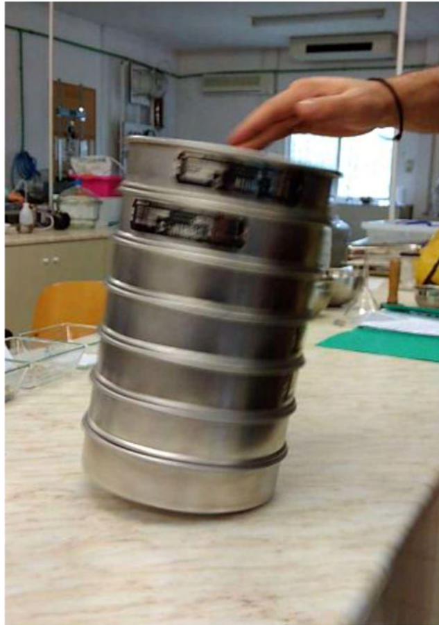
Σχήμα 4.11 Διαβάθμιση χονδροκόκκων υλικών για την παρασκευή εδαφικού φίλτρου
