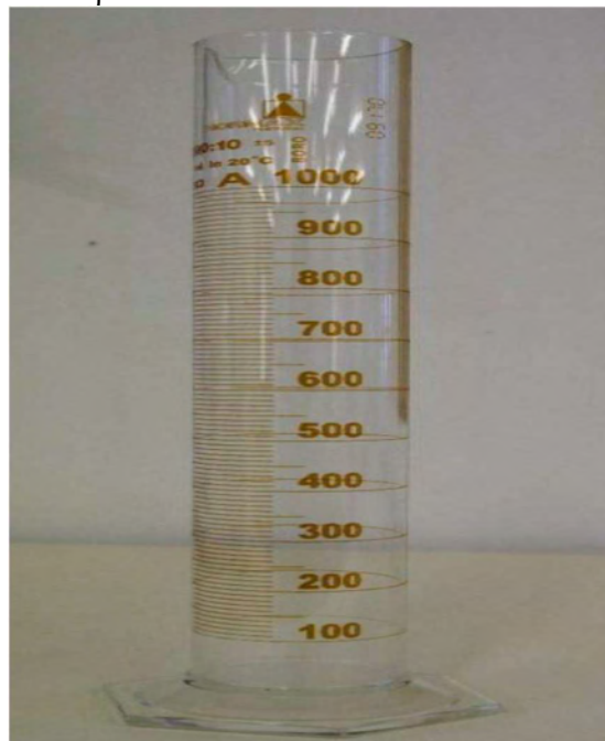
Σχήμα 4.6 Ογκομετρικός κύλινδρος για τη μέτρηση της παροχής
