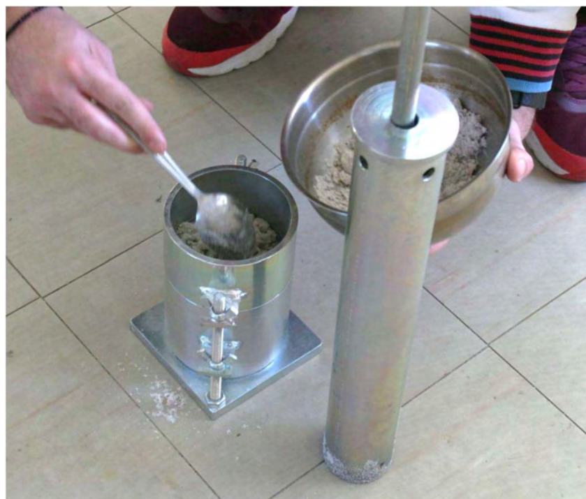
Σχήμα 5.13 Τοποθέτηση του εδαφικού δοκιμίου στη μήτρα Proctor
