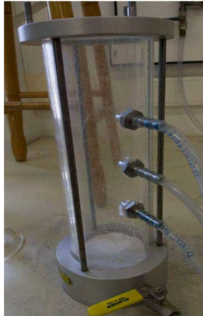
Σχήμα 4.17 Τοποθέτηση χάρτινου φίλτρου, στην κάτω βάση της κυψέλης δοκιμίου
