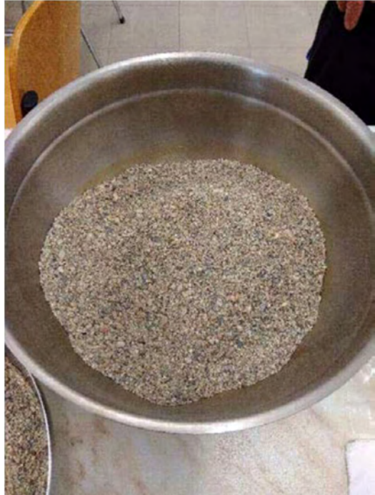
Σχήμα 4.13 Σύνθεση ενός εδαφικού φίλτρου, 1kg, με κατάλληλες ποσότητες από κάθε διάμετρο κόκκων
