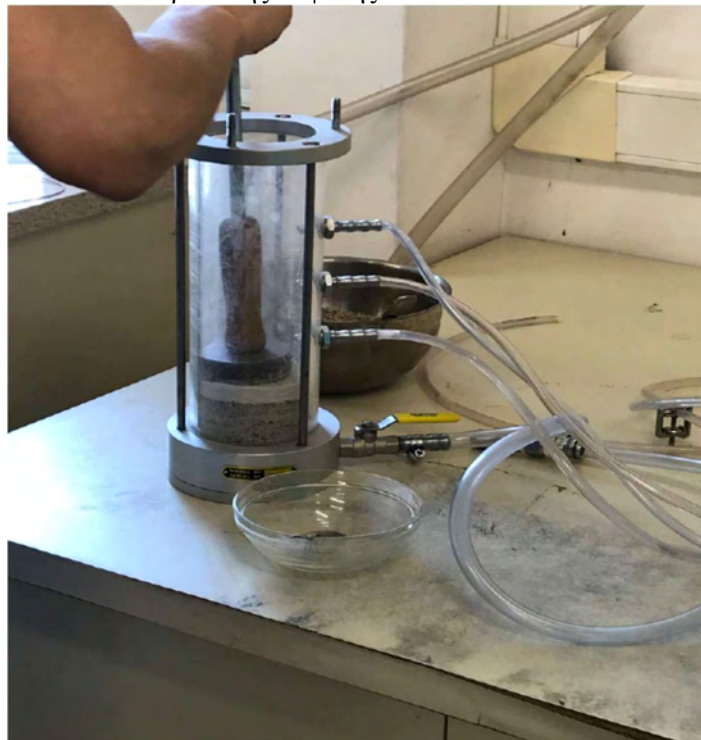
Σχήμα 4.20 Συμπύκνωση της πρώτης στρώσης του εδαφικού δοκιμίου
