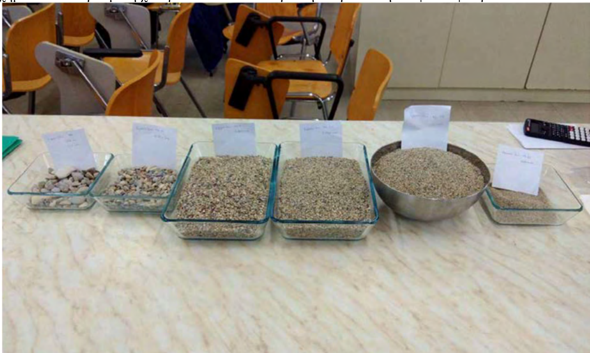
Σχήμα 4.12 Διαχωρισμός του εδαφικού υλικού με βάση την διάμετρο τους για την παρασκευή του εδαφικού φίλτρου
