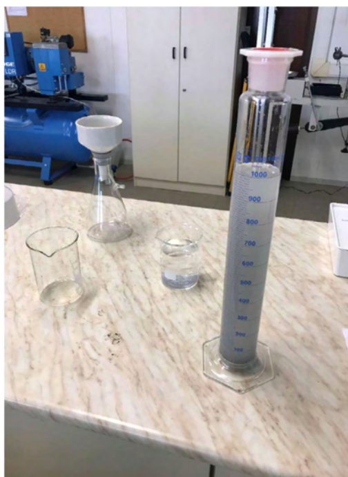
Σχήμα 5.5 Δοκιμή υγρής κοκκομετρίας με κόσκινα
