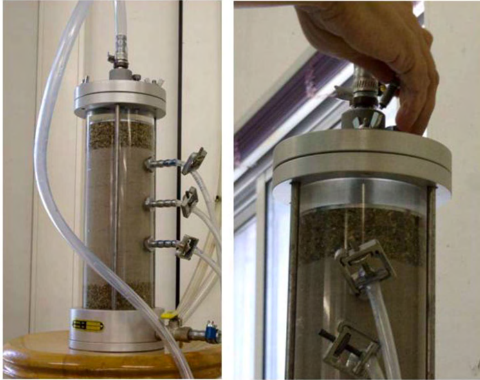
Σχήμα 4.25 Δοκίμιο μετά την ολοκλήρωση της διαδικασίας του κορεσμού και άνοιγμα της ειδικής βαλβίδας για την πλήρη απομάκρυνση του CO 2 από το εσωτερικό της κυψέλης.
