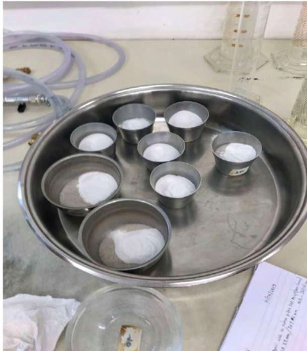
Σχήμα 4.19 Κατάλληλες ποσότητες του εξεταζόμενου εδαφικού υλικού (μίγμα άμμου και ιλύος) για τη διαμόρφωση του δοκιμίου στο εσωτερικό της κυψέλης
