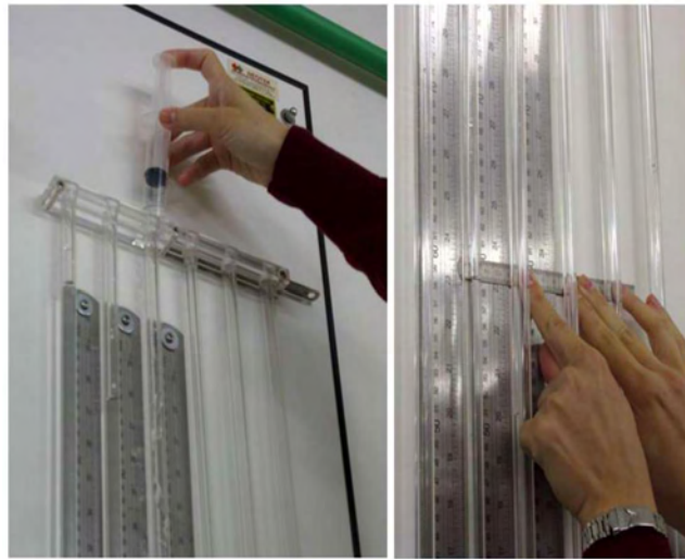
Σχήμα 4.9 Συμπλήρωση κατάλληλης ποσότητας νερού στα μανόμετρα
