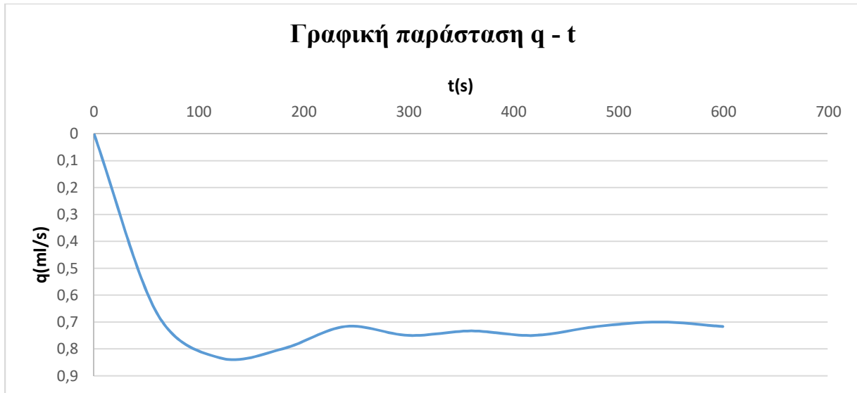
Σχήμα 6.11 Μεταβολή της παροχής, q , κατά τη διάρκεια της δοκιμής, χρόνος t , με τον τρόπο (α) για την 4 η δοκιμή και το δοκίμιο με D_r=88\%
