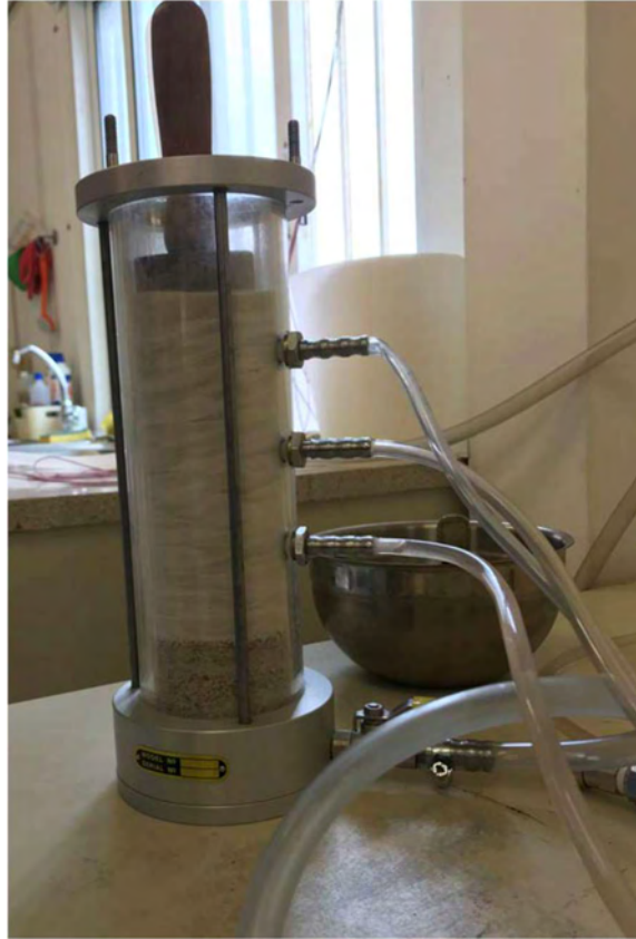
Σχήμα 4.21 Συμπύκνωση της τελικής στρώσης του εδαφικού δοκιμίου
