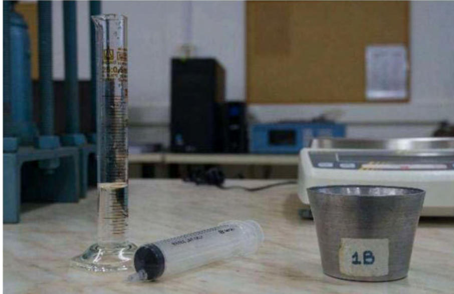
Σχήμα 4.7 Ογκομετρικός κύλινδρος, σύριγγα και υποδοχέας για τη διαδικασία βαθμονόμησης των μανομέτρων
