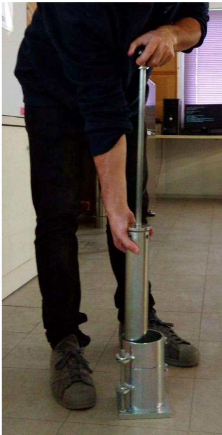
Σχήμα 5.14 Συμπύκνωση εδαφικού δοκιμίου με σφύρα στη δοκιμή Proctor
