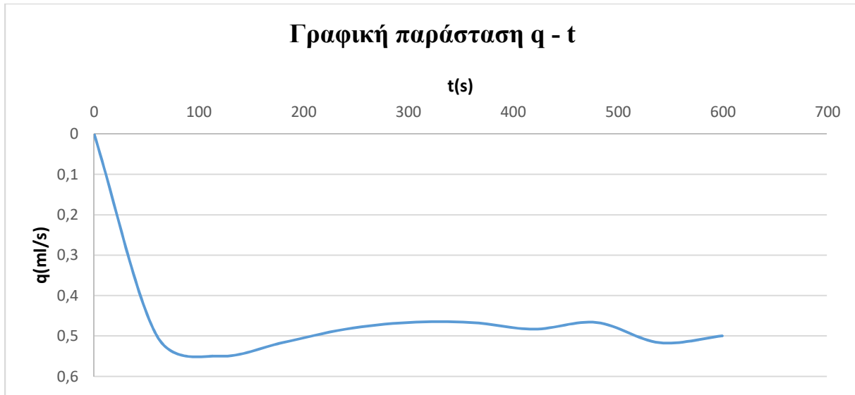
Σχήμα 6.7 Μεταβολή της παροχής, q , κατά τη διάρκεια της δοκιμής, χρόνος t , με τον τρόπο (α) για τη 2 η δοκιμή και το δοκίμιο με D_r=88\%
