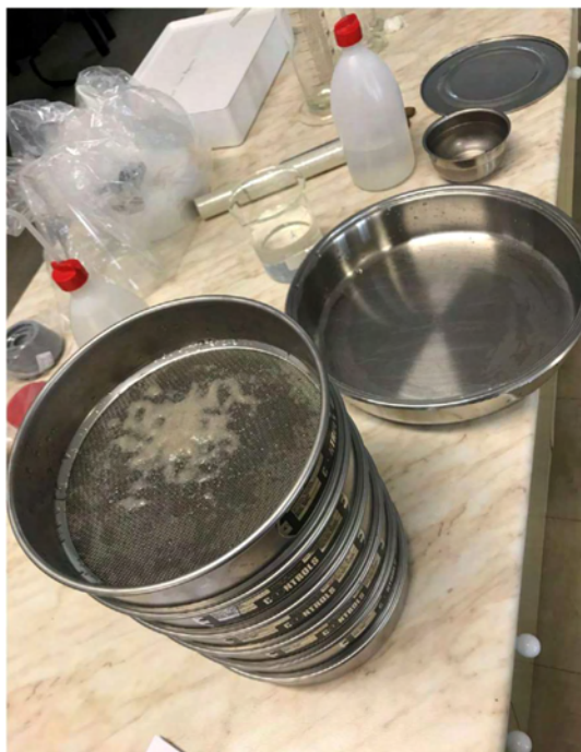
Σχήμα 5.5 Δοκιμή υγρής κοκκομετρίας με κόσκινα
