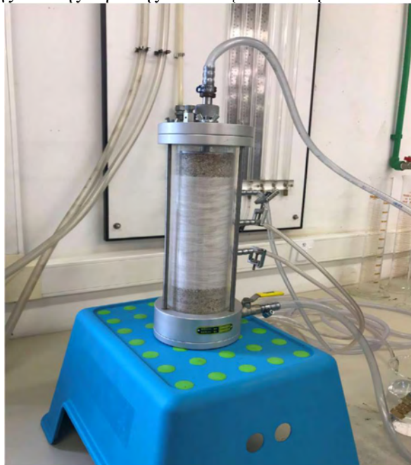
Σχήμα 4.22 Κυψέλη με το εδαφικό δοκίμιο
