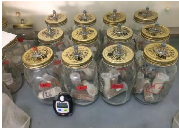
Εικόνα 22: Γυάλινα βάζα 1 l, τα οποία σφραγίστηκαν και εξετάστηκαν για διαρροές.
