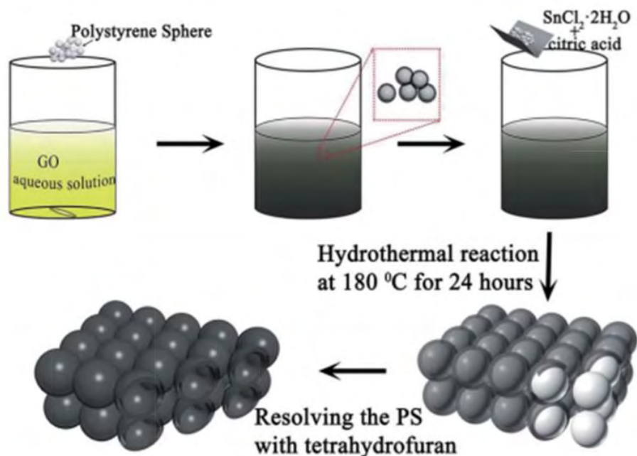
Εικόνα 3.5 Σχηματική αναπαράσταση της σύνθεσης SnO 2 / οξειδίου του γραφενίου 113 .
