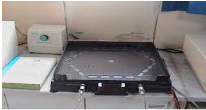
Εικόνα 3: Συσκευή ηλεκτροφόρησης σε παλλόμενο ηλεκτρικό πεδίο.
