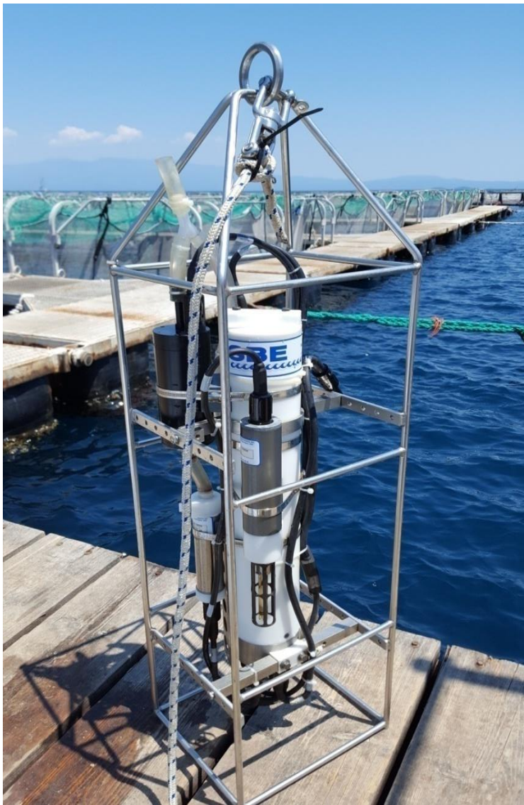
Εικόνα 2.2: Αυτογραφικό όργανο καταγραφής φυσικοχημικών και βιολογικών χαρακτηριστικών του νερού της εταιρείας Sea Bird Electronics.
