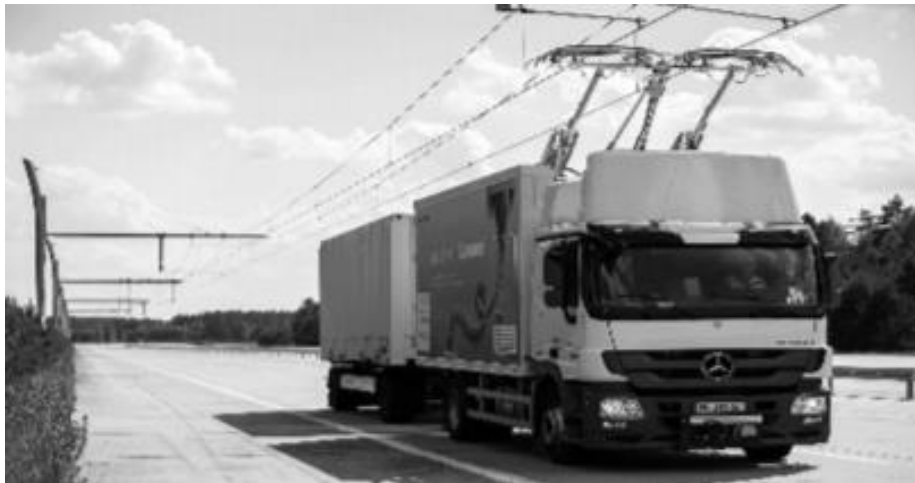
Εικόνα 14. Ηλεκτροκίνηση μέσω ρευματολήπτη μετακινούμενου ηλεκτροκινητήρα για οχήματα βαρέου τύπου από τη Siemens [47].
