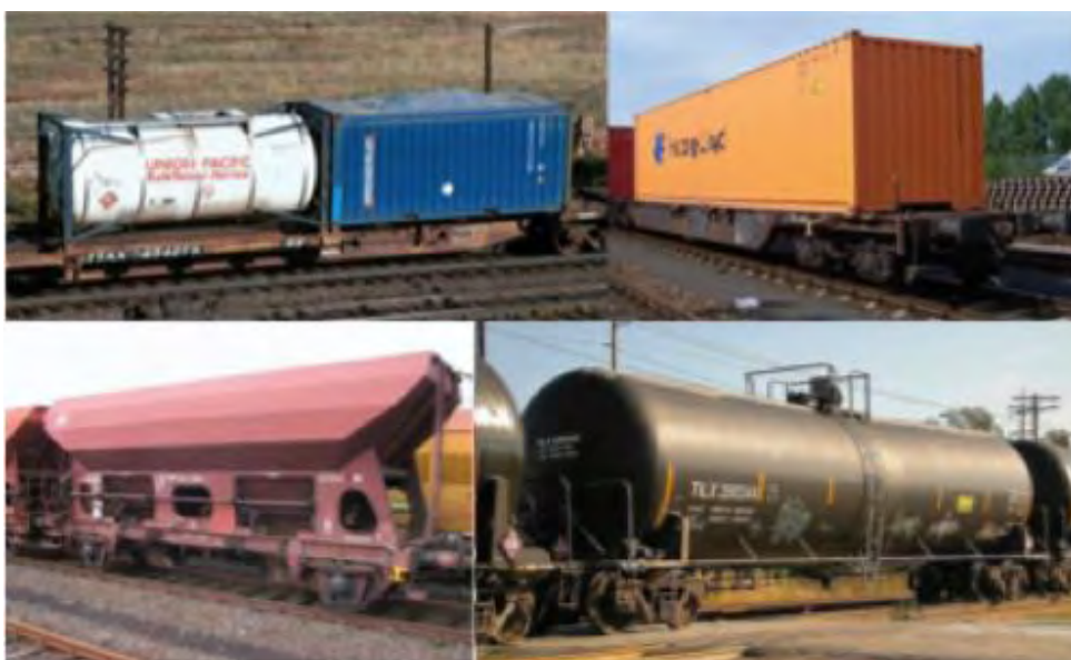
Εικόνα 3. Αυτοκινητάμαξες με αποσπώμενα (α, β) και μη αποσπώμενα (γ, δ) φορτία: (α) αποσπώμενο tank container (αριστερά) και εμπορευματοκιβώτιο ανοιχτής οροφής (δεξιά), (β) διατροφικό εμπορευματοκιβώτιο σε flatcar, (γ) εμπορευματοκιβώτιο για μεταφορά μη
