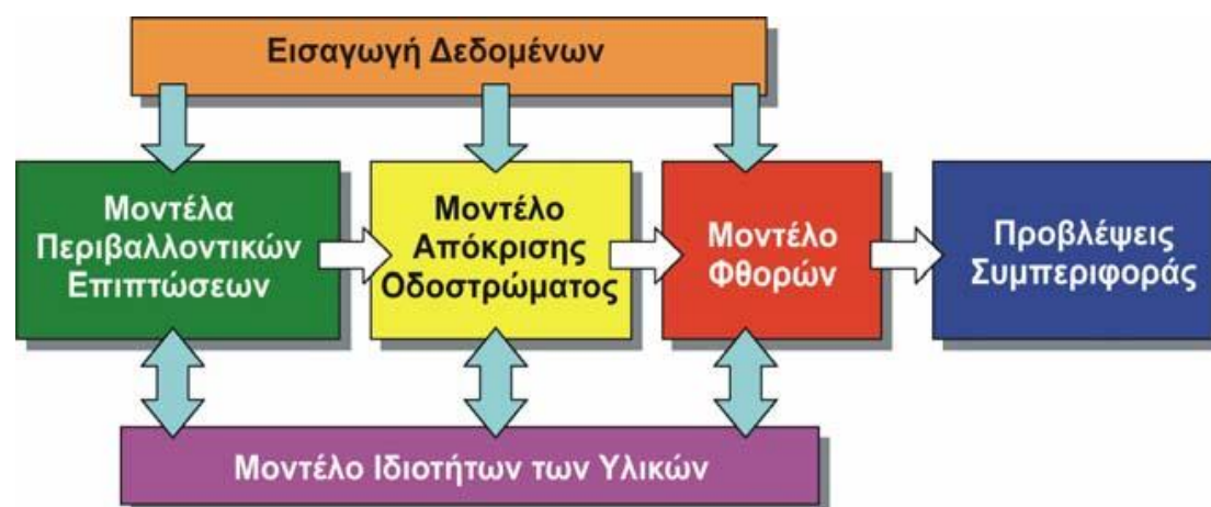
Σχήμα 2.16: Τυπική διαδικασία ανάπτυξης μοντέλων πρόβλεψης της κατάστασης του οδοστρώματος [Πηγή: Harman, 2001]
