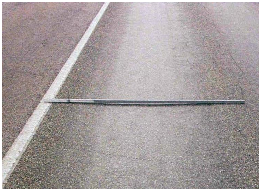
Σχήμα 4.3: Παράδειγμα μόνιμης παραμόρφωσης σε εύκαμπτο οδόστρωμα
