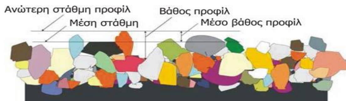
Σχήμα 2.11: Υπολογισμός του μέσου βάθους προφίλ οδοστρώματος [Πηγή: Greenwood Engineering]
