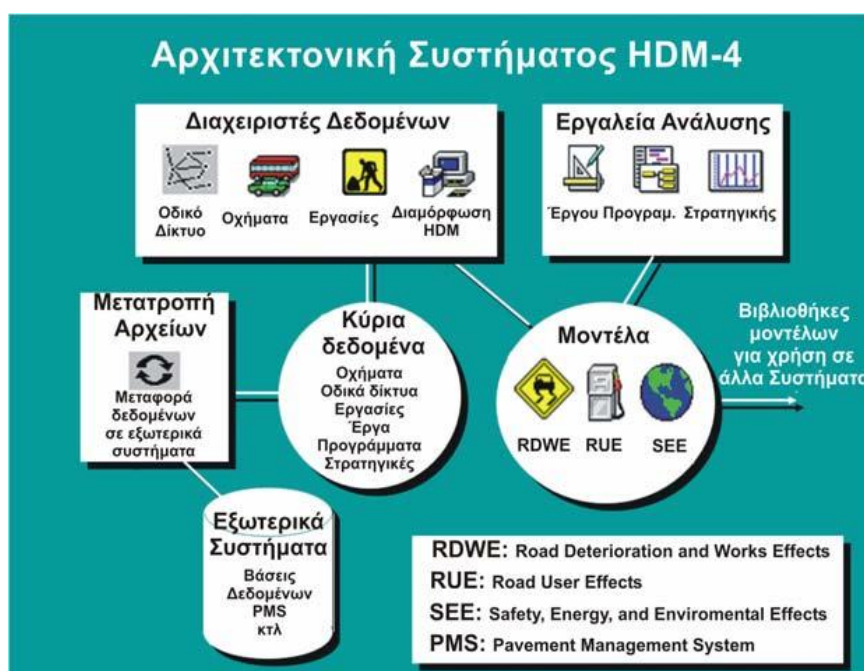
Σχήμα 2.2: Αρχιτεκτονική του συστήματος HDM-4 [Πηγή: World Bank, 2007]
