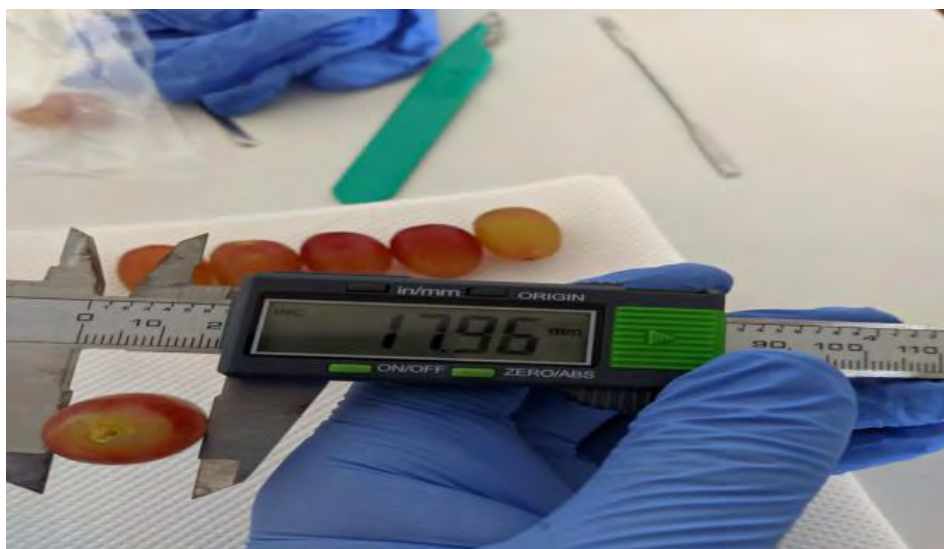
Φωτογραφία 2.8. Προσδιορισμός μήκους και πάχους ραγών της ποικιλίας Crimson seedless με ηλεκτρονικό ψηφιακό παχύμετρο ακριβείας.
