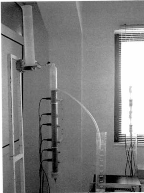
Εικόνα 4.2 Πειραματική διάταξη για τη μελέτη της αθροιστικής διήθησης
