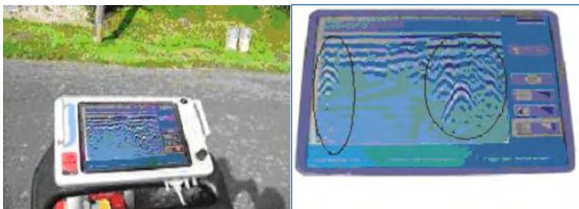
Εικόνα 5.4 Εντοπισμός διαρροών με τη χρήση γεωραντάρ (Pilcher et al., 2008)
