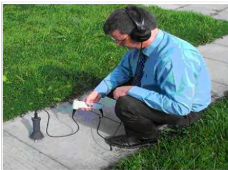
Εικόνα 5.3 Τεχνικός διαρροών που χρησιμοποιεί γαιόφωνο (Pilcher et al., 2008)
