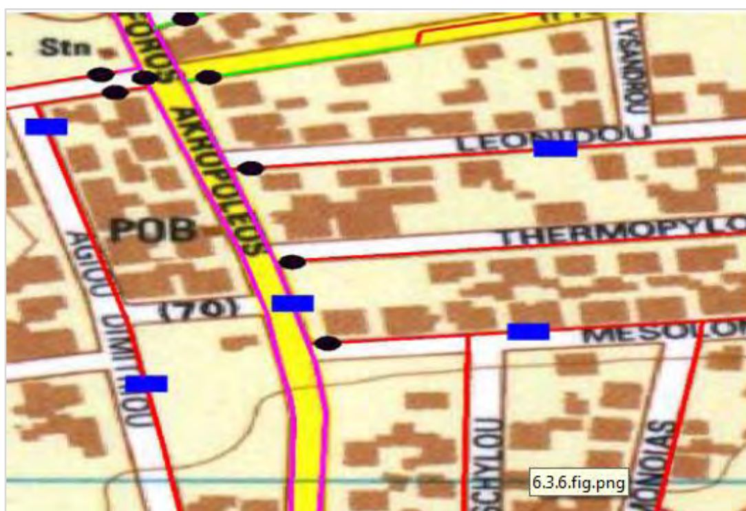
Σχήμα 5.4 Τοποθετήσεις ακουστικών καταγραφέων μέσα σε ένα σύστημα διανομής (Kazantzis et al., 2003)
