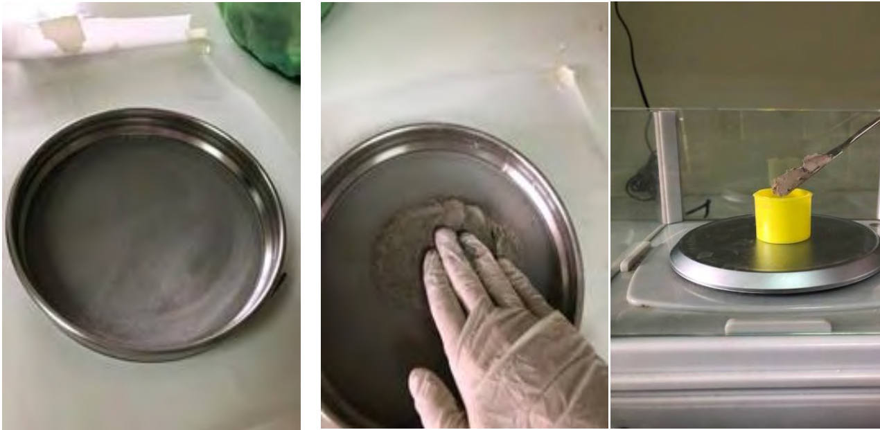
Εικόνα 2.3: Κόσκινο 2mm, διαδικασία κονιοποίησης και τοποθέτηση σε αεροστεγή βάζα
