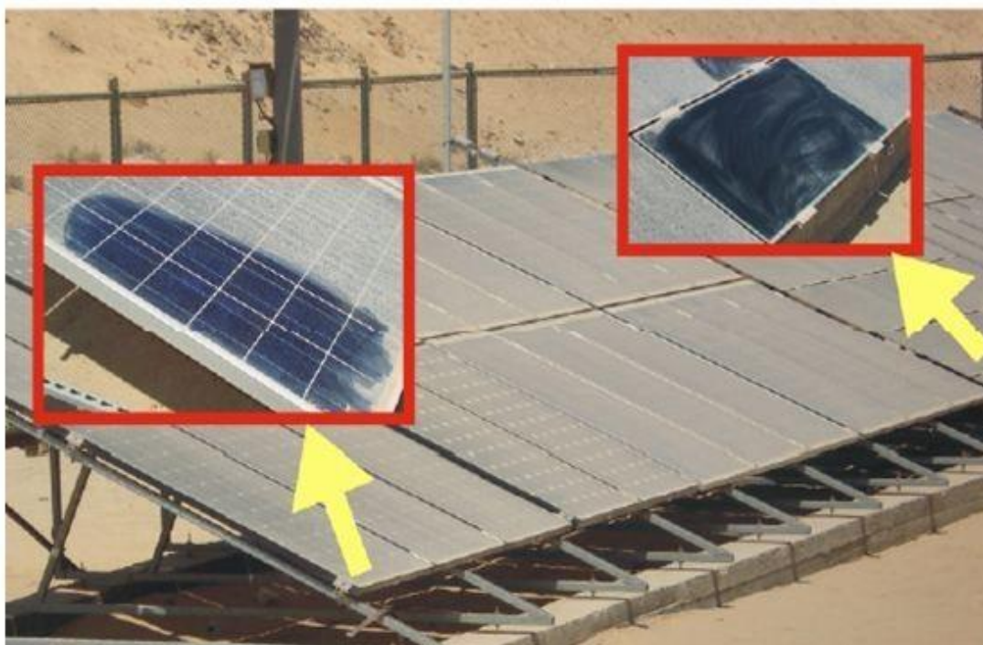
Εικόνα 4.1: Σκόνη σε Φ/Β πάνελ στην Αίγυπτο. (Πηγή: Makrides et al, 2012)
