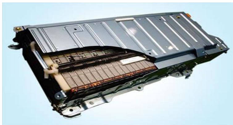
Εικόνα 3.2.3: Συσσωρευτές Νικελίου – Μετάλλου Υδριδίου (Ni-MH) του μοντέλου Toyota Prius[62]
