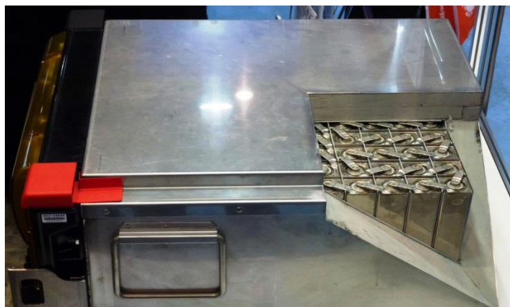
Εικόνα 3.2.5 : Συσσωρευτής Χλωριδίου – Μεταλλικού Νατρίου (Sodium Metal Chloride – «Zebra»)[67]
