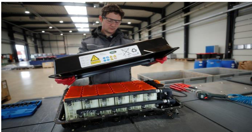
Εικόνα 3.2.4β: Συστοιχία συσσωρευτών λιθίου – ιόντων από Land Rover[65]
