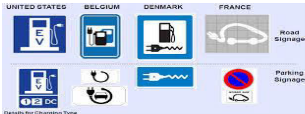
Εικόνα 5.6 : Παραδείγματα σήμανσης σταθμού φόρτισης [130]
