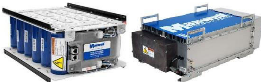
Εικόνα 3.2.9 : Υπερπυκνωτής ηλεκτροκίνητων οχημάτων της Maxwell (Tesla Motors)[74]
