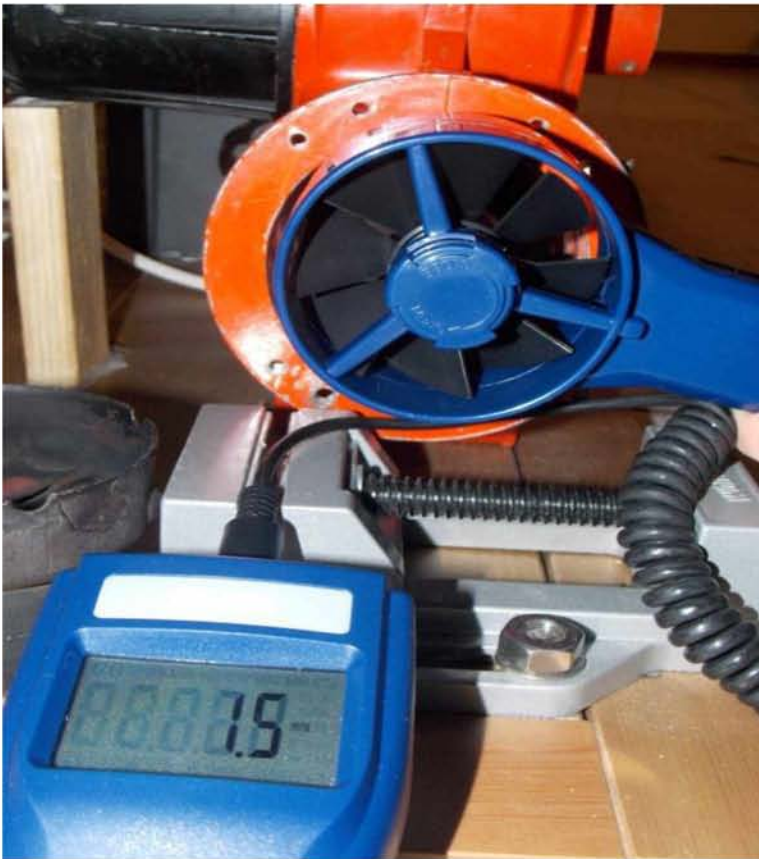
Εικόνα 11: Μέτρηση της μέσης ταχύτητας free delivery στην έξοδο του ανεμιστήρα με ανεμόμετρο τύπου τουρμπίνας
