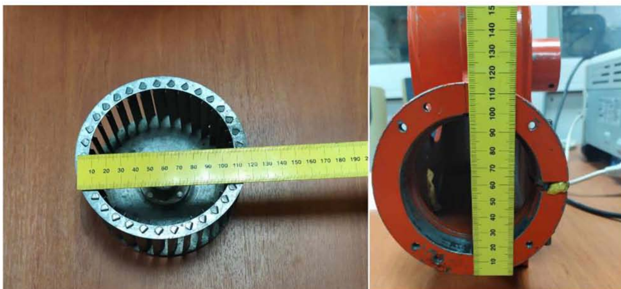
Εικόνα 9: Μέτρηση της διαμέτρου στην πτερωτή και στην έξοδο του ανεμιστήρα
