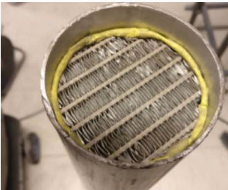
Εικόνα 15: Δείγμα από τον πυρήνα του ψυγείου στην έξοδο του προσαρμομένου σωλήνα
