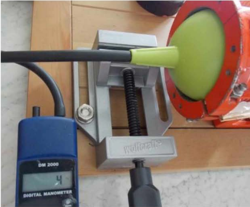
Εικόνα 12: Μέτρηση της πίεσης ανακοπής στην έξοδο του ανεμιστήρα για συχνότητα διέγερσης 5 Hz
