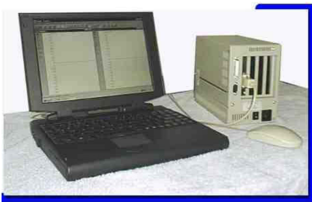
Εικόνα 4. Η ηλεκτρική διάταξη και ο υπολογιστής για την καταγραφή μέσω λογισμικού ( Clamp version 2.14 software: AC Micro-Clamp, Aachen, Germany )
