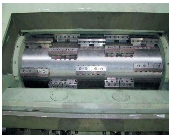
Εικόνα 4.2: Κοκκοποιητής - Η θέση του είναι μετά τον τεμαχιστή και σκοπό έχει να μειώνει αισθητά το μέγεθος των κόκκων
