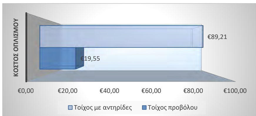
Σχήμα 5.3: Συγκριτικό διάγραμμα κόστους απαιτούμενου οπλισμού για τοίχο πρόβολο και τοίχο με αντηρίδες
