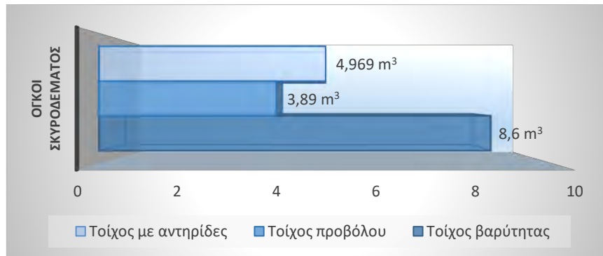
Σχήμα 5.1: Συγκριτικό διάγραμμα απαιτούμενου όγκου σκυροδέματος για κάθε τοίχο
