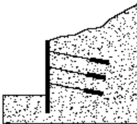
Σχήμα 4.5: Τυπική διατομή αγκυρωμένου τοίχου (Αβρανά, 2006)
