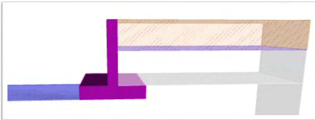
Εικόνα 5.10: Τρισδιάστατη απεικόνιση τοίχου πρόβολου
