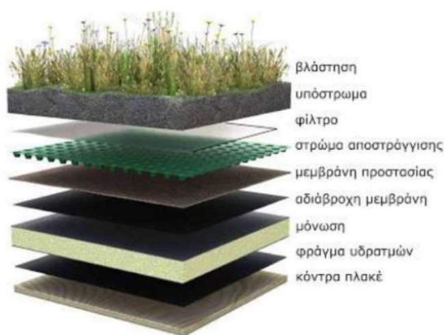
Εικόνα 6.5: Απαραίτητα στρώματα για τη φύτευση στα δώματα
