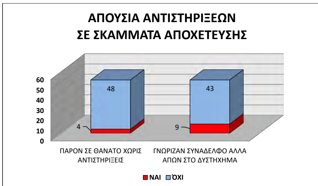
Σχήμα 4: Απουσία αντιστηρίξεων σε σκάμματα αποχετεύσεων
