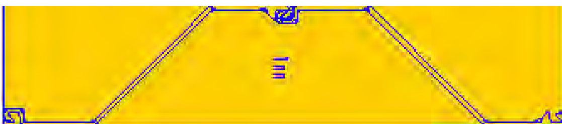
Εικόνα 14: Τύποι συνδέσεων πασσαλοσανίδων, σχήματος Z
