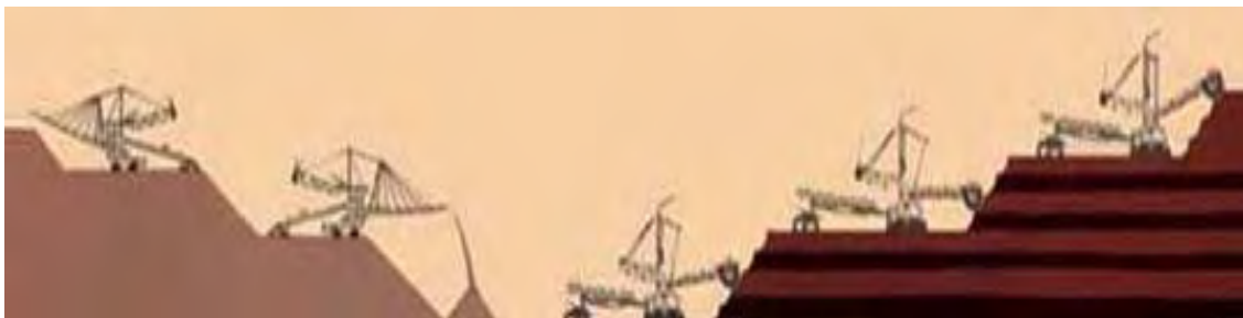
Σχήμα 4.2: Σχηματική παράσταση των ορυχείων με του εκσκαφείς στα δεξιά και τους αποθέτες στα αριστερά, με συνολική κίνηση του συστήματος προς τα δεξιά
