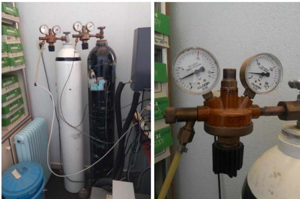
Εικόνα 5.24: Φιάλες με αέρα υπό πίεση για την λειτουργία των εμβόλων
