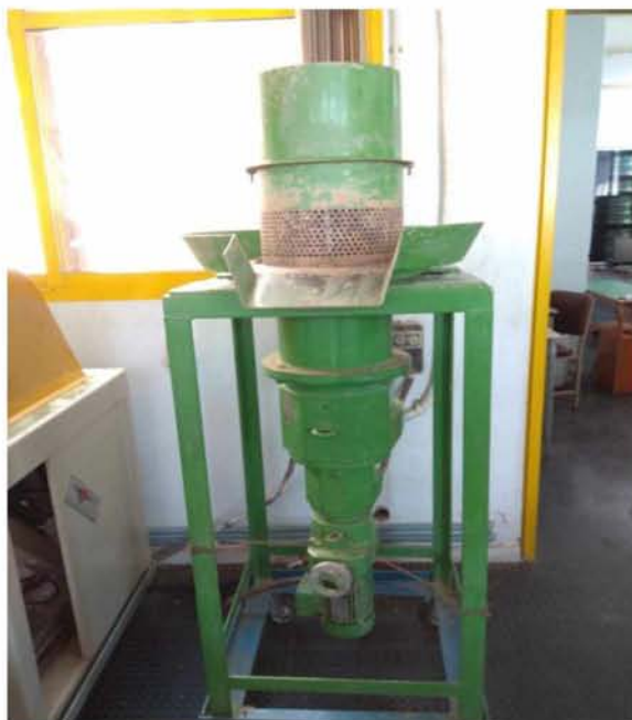
Εικόνα 5.1.α: Συσκευή άλεσης
