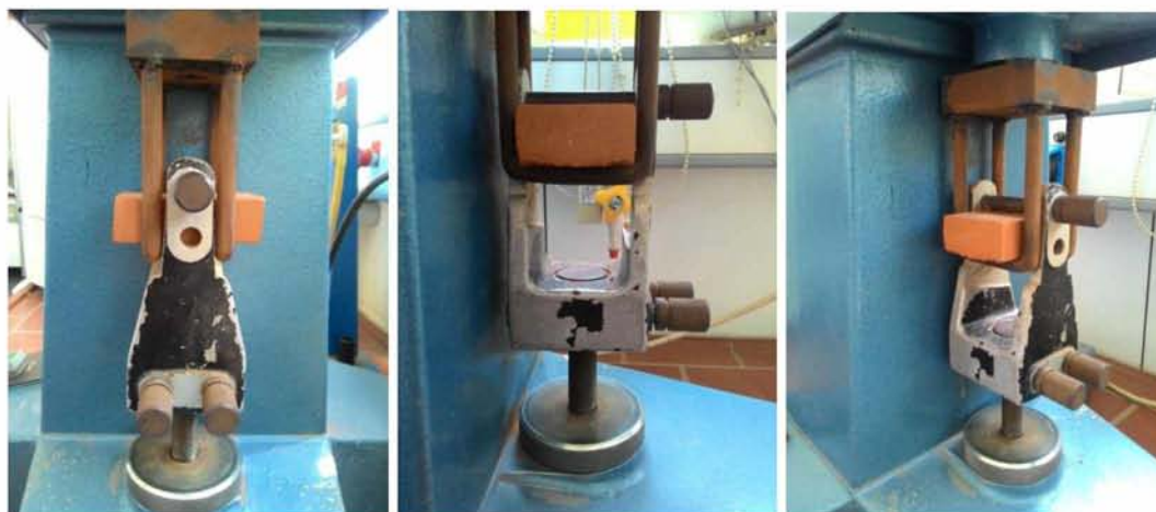
Εικόνα 5.29: Μέρη εμβόλου συσκευής MOR
