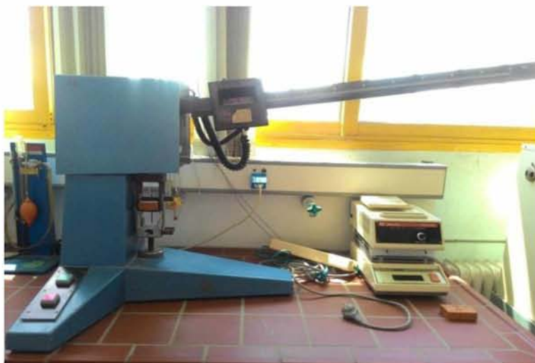
Εικόνα 5.28: Γενική διάταξη συσκευής κάμψης 3 σημείων (MOR)
