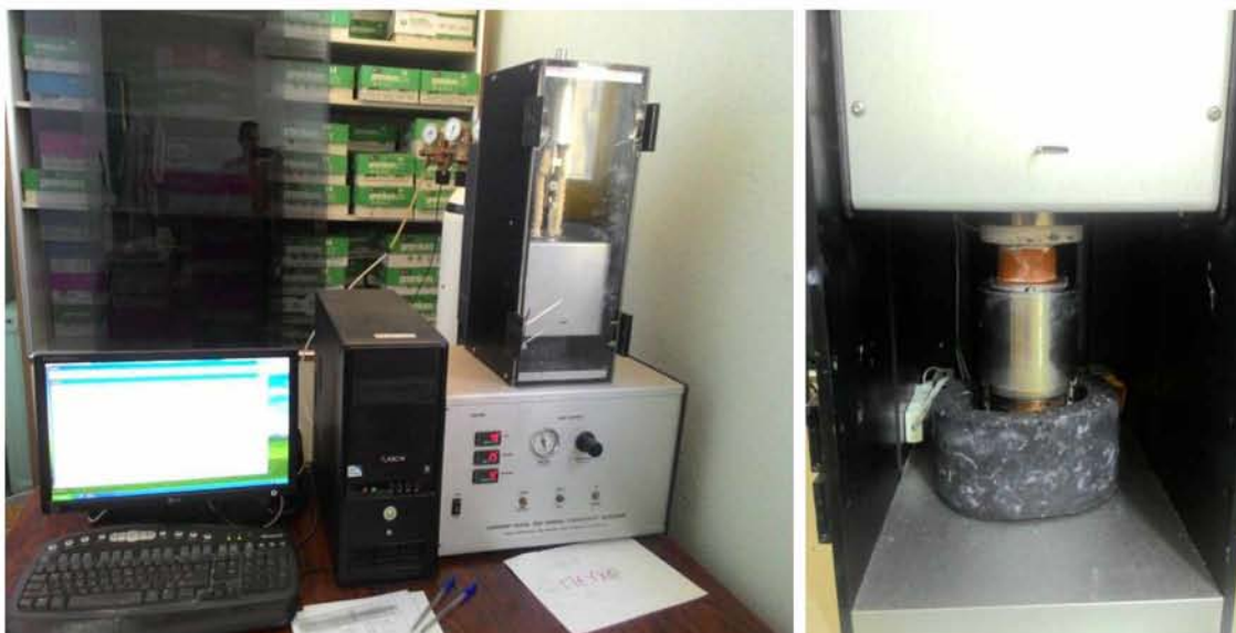
Εικόνα 5.23:Συσκευή θερμικής αγωγιμότητας
