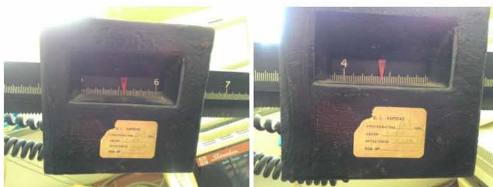
Εικόνα 5.30: Βαθμονομημένη οδοντωτή κλίμακα με ηλεκτρικά κινούμενο δείκτη
