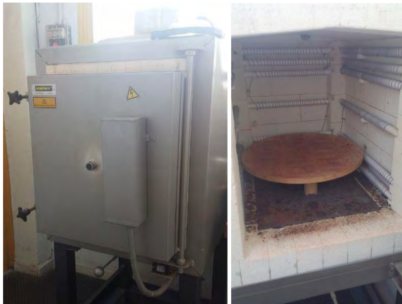
Εικόνα 4.8.: Φούρνος όπτησης (εξωτερική και εσωτερική όψη)
