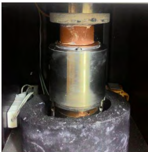
Εικόνα 4.30.: Δοκίμιο με θερμοαγώγιμη σιλικόνη
