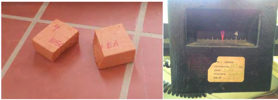
Εικόνα 4.29.: Ένδειξη φορτίου αστοχίας (σε kN) κεραμικού δοκιμίου
