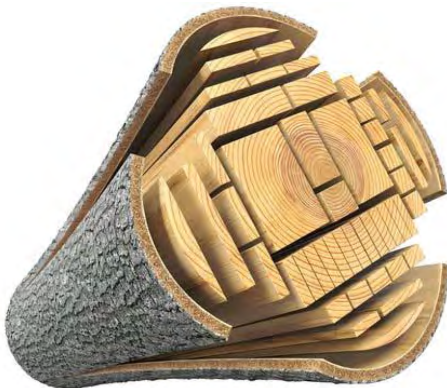
Εικόνα 3.2.: Τρόπος πρίσης και παραγωγής πριστών από κορμοτεμάχιο (πηγή: http://users.auth.gr/ptsioras/pdf )
