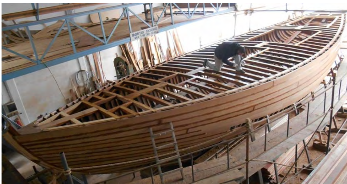
Εικόνα 3.4.: Κατασκευή ξύλινου σκάφους
