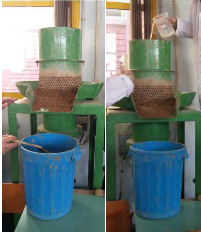
Εικόνα 4.11.: Άλεση υλικού και προσθήκη νερού στον αναμικτήρα
