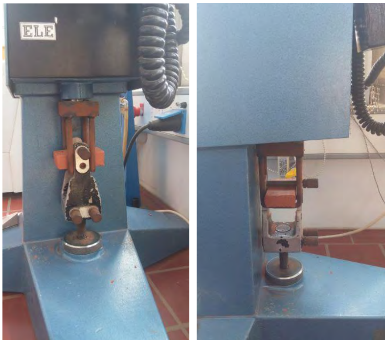
Εικόνα 4.28.: Δοκίμια στη συσκευή για μέτρηση της αντοχής σε κάμψη
