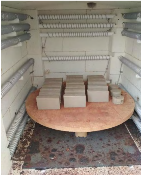
Εικόνα 4.20.: Κεραμικά δοκίμια στον φούρνο όπτησης
