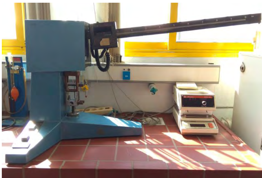
Εικόνα 4.23.: Συσκευή για τον έλεγχο κάμψης 3 σημείων
