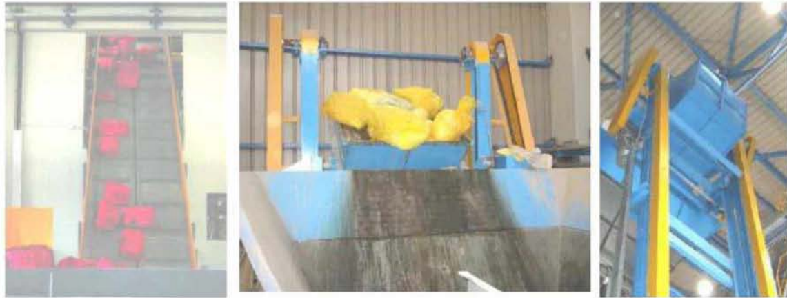
Εικόνα 10: Τροφοδοσία του κλιβάνου με ταινιόδρομους και με αναβατόριο (ΕΣΔΚΝΑ,2007)
