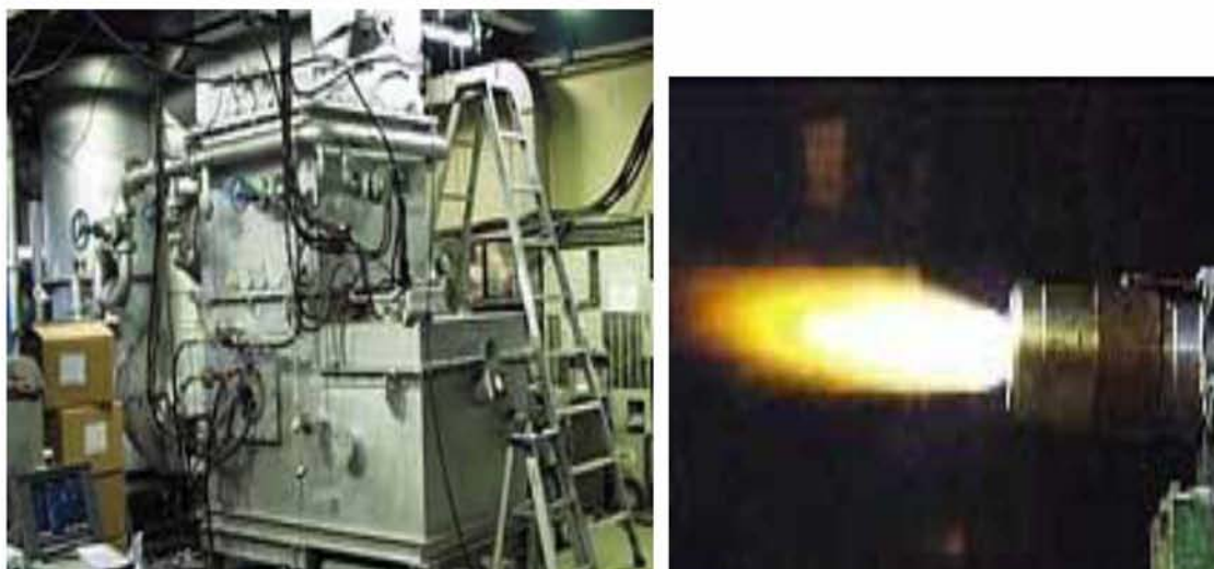
Εικόνα 13: Εξοπλισμός επεξεργασίας μολυσματικών αποβλήτων με πλάσμα, πυρός πλάσματος
