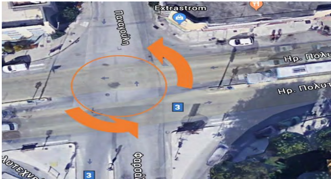
Σχήμα 5-4: Σημείου τοποθέτησης κυκλικού κόμβου στην διασταύρωση Ηρώων Πολυτεχνείου και Φαρσάλων/Παναγούλη για να αυξηθεί η εξυπηρέτηση του τμήματος 5 στην υπό μελέτη οδό.
