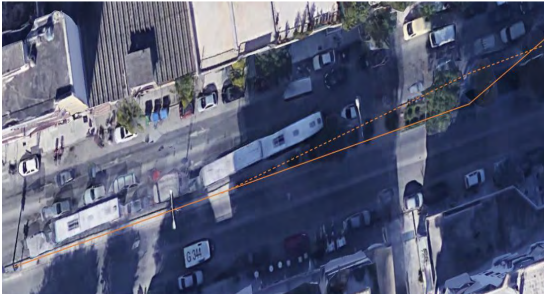
Σχήμα 5-3: Τροποποίηση στο μήκος της αριστερής ειδικής λωρίδας για την αποφυγή υπερχειλίσης της και παρεμπόδισης της κυκλοφορίας στην κοινή λωρίδα (από δορυφορικό χάρτη, Google earth).
