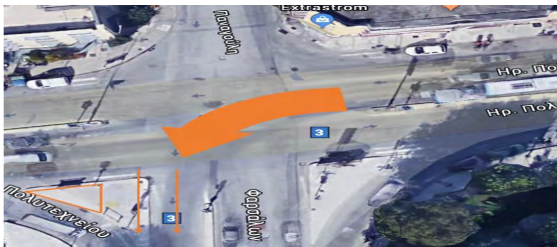
Σχήμα 5-2: Τροποποίηση νησίδα στην διασταύρωση Φαρσάλων και Ηρώων Πολυτεχνείου στο ρεύμα κυκλοφορίας με κατεύθυνση τα Φάρσαλα, ώστε να δημιουργηθούν 2 λωρίδες αριστερής κίνησης στην διατομή του τμήματος 5 (από δορυφορικό χάρτη, Google earth).
