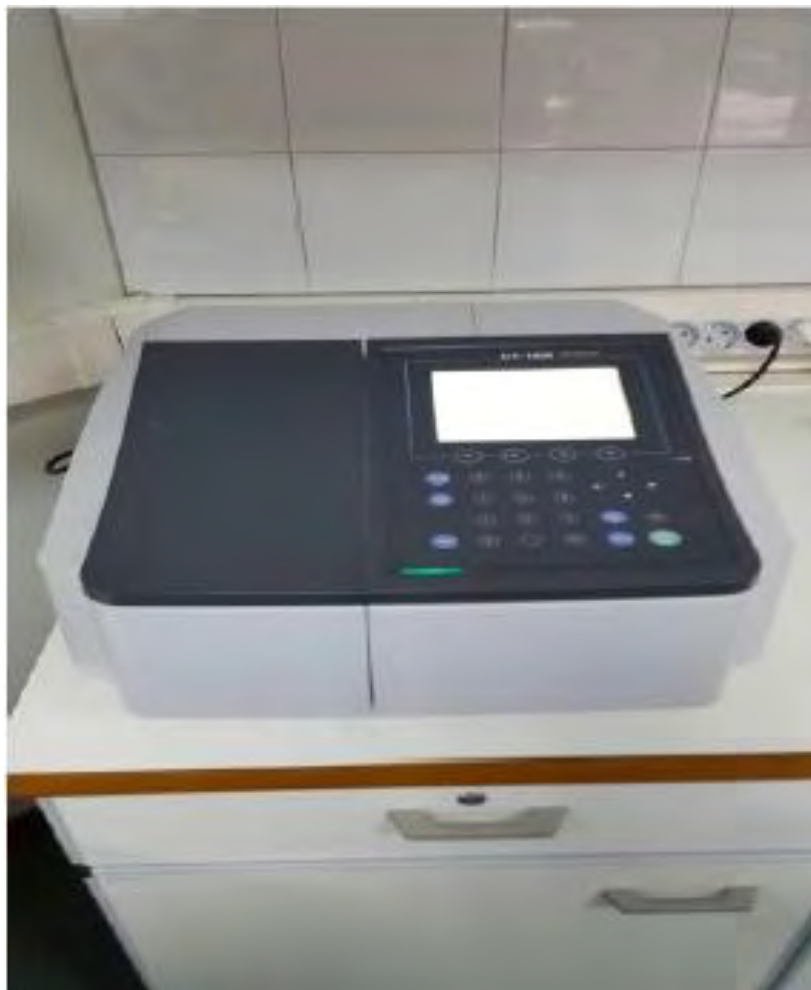
Εικόνα 2.4: Φασματοφωτόμετρο SHIMADZUUV-1800 για τις αναλύσεις των θρεπτικών αλάτων του νερού.
