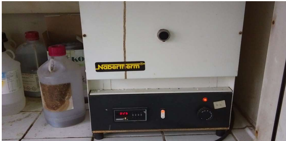
Εικόνα 5: Ο φούρνος στον οποίο τοποθετήθηκαν οι κάψες για 24 ώρες στους 500 °C.
