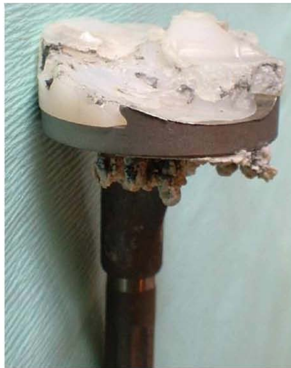
Εικόνα 7-4. Αναθεώρηση λόγω φθοράς πολυαιθυλενίου.
