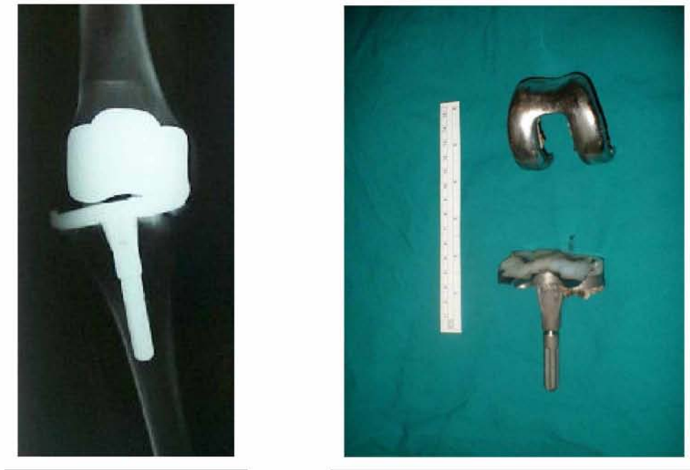
Εικόνα 7-5. Θραύση πολυαιθυλενίου από επαναλαμβανόμενες πτώσεις.
