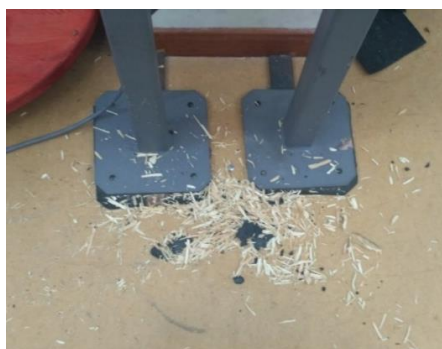
Εικόνα 56α-β: Φθορά στόχων έρευνας: α) διαμπερής τρύπα, β) θραύσματα (ξύλο – καουτσούκ) Πηγή: Προσωπικό αρχείο Πετμεζά Σταύρου (FAME LAB)
