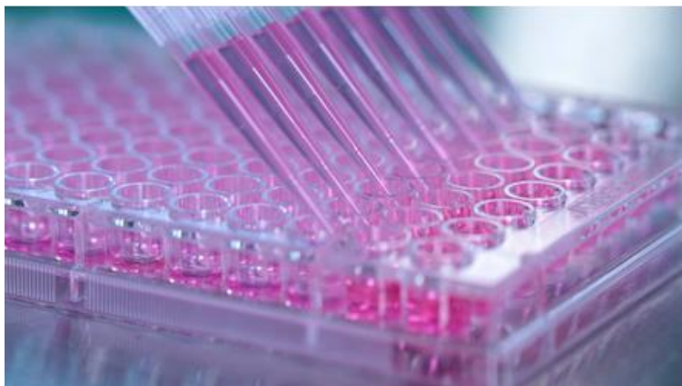
Εικόνα 2.12: Χρήση πολυπιπέτας για την προσθήκη MTT, ΧΤΤ/PMS και LDH.
