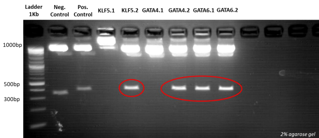
Εικόνα 27. Ηλεκτροφόρηση διαγνωστικής πέψης για τον φορέα pSiCOR σε πήκτωμα αραρόζης 2%. Στην πρώτη στήλη φαίνονται οι ζώνες του Ladder 1Kb. Ακολουθεί ο αρνητικός μάρτυρας (άκοπος φορέας) με τη δεύτερη ζώνη κοντά στις 330bp, έπειτα ο θετικός μάρτυρας με τη δεύτερη ζώνη κοντά στις 370bp. Στη συνέχεια παρατίθενται τα υπό εξέταση δείγματα KLF5/GATA4/GATA6. Ελέγχθηκαν 2 μοναδιαίες αποικίες για κάθε πλασμιδιακή κατασκευή (π.χ. KLF5.1 και KLF5.2). Σε κόκκινο πλαίσιο σημειώνονται οι ζώνες των δειγμάτων που ευθυγραμμίζονται με τη ζώνη του θετικού μάρτυρα στις 370bp.
