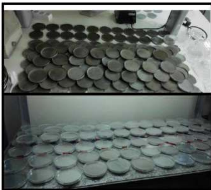
Εικόνα 3: επιφάνειες τριβλίων τσιμέντου και μετάλλου
