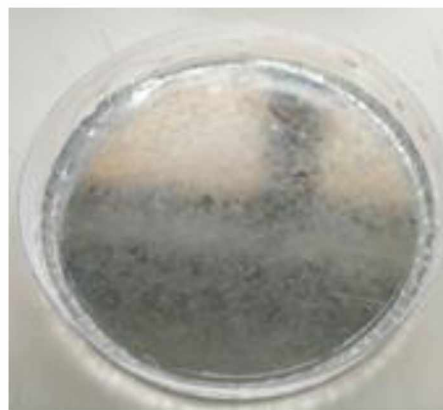
Εικόνα 6. Τρυβλίο Petri με επιφάνεια μετάλλου στον πυθμένα και περιφερειακό σφράγισμα με σιλικόνη.
