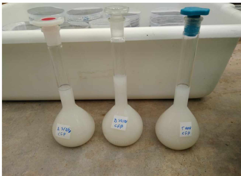
Εικόνα 3. Ψεκαστικά διαλύματα (A, B, C) σε ογκομετρικές φιάλες των 100mL.
