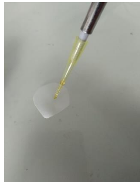
Εικόνα 37: Εμποτισμός διηθητικού χαρτιού με αιθέριο έλαιο
