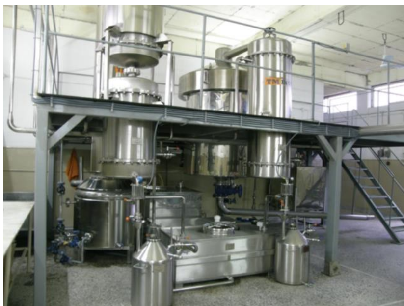
Εικόνα 3: Αποστακτήρας για την απόσταξη ροδοπέταλων Rosa damascena και την παραλαβή αιθέριου ελαίου στη Κοζάνη
