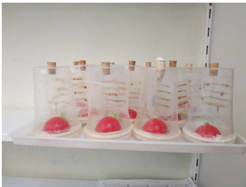
Εικόνα 8: Πλαστικά διαφανή κλουβιά που χρησιμοποιήθηκαν για τη μελέτη των δημογραφικών χαρακτηριστικών των ενηλίκων της μύγας της Μεσογείου
