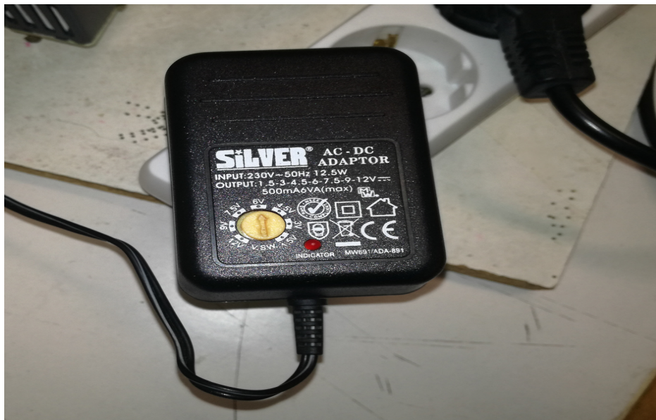
Εικόνα 4.3 Ο μετασχηματιστής- ανορθωτής τάσης του ανεμιστήρα.
