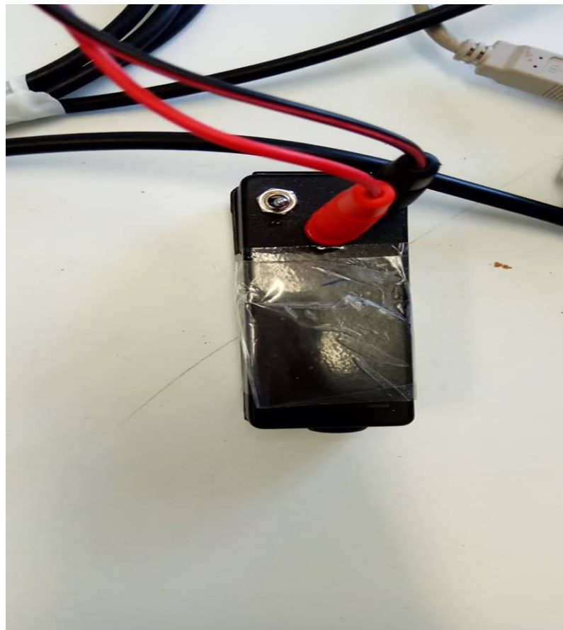
Εικόνα 3.11 Η Συσκευή μετατροπής σήματος-προσομοίωσης της εναλλαγής θερμότητας στον πυρήνα
