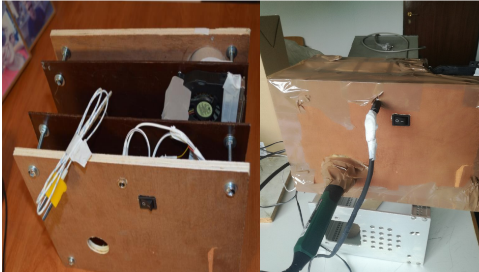
Εικόνα 3.6 Τοποθέτηση διακόπτη On/Off του ανεμιστήρα
