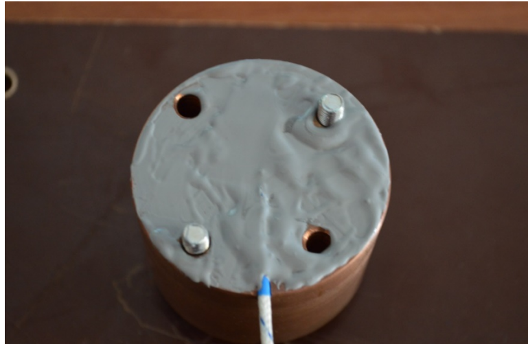
Εικόνα 3.2 Θερμικά αγωγή πάστα
