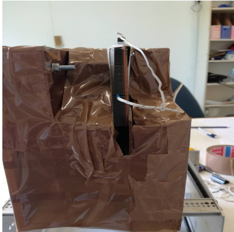
Εικόνα 3.8 Το θερμοστοιχείο στα πτερύγια ψύξης του ανεμιστήρα
