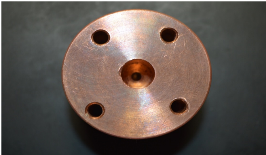
Εικόνα 3.1 Ο κύλινδρος από χαλκό και οι 5 οπές που δημιουργήσαμε
