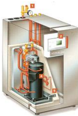
Εικόνα 8. Γεωθερμική αντλία θερμότητας [19]
