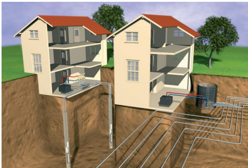
Εικόνα 7. Σύστημα γεωθερμίας κλειστού κυκλώματος κάθετο/ οριζόντιο [18]
