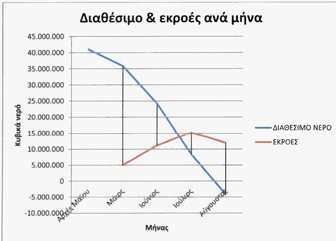
Σχήμα 6.4: Η καμπύλη του διαθέσιμου νερού στο φράγμα, συναρτήσεως των εισροών και εκροών του κάθε μήνα άρδευσης.
