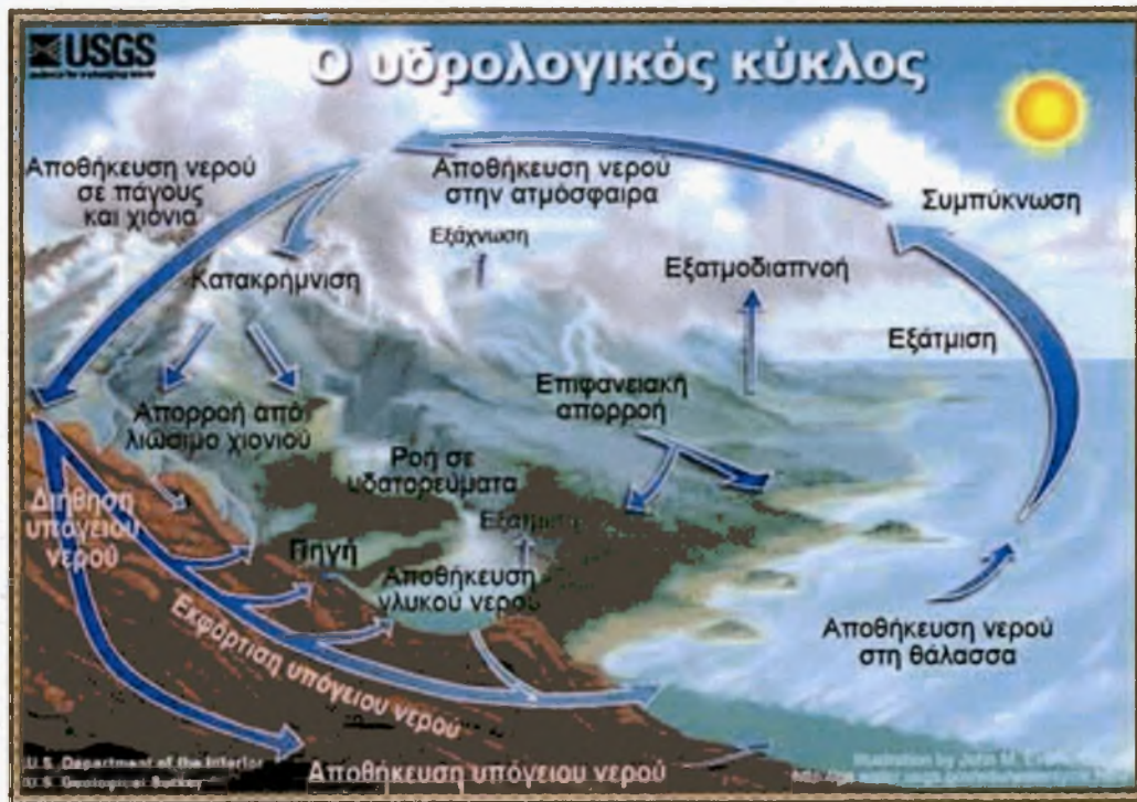
Εικόνα 1.1: Σχηματική απεικόνιση του υδρολογικού κύκλου (US Department of the Interior US Geological Survey, http://www.usgs.gov/ )
