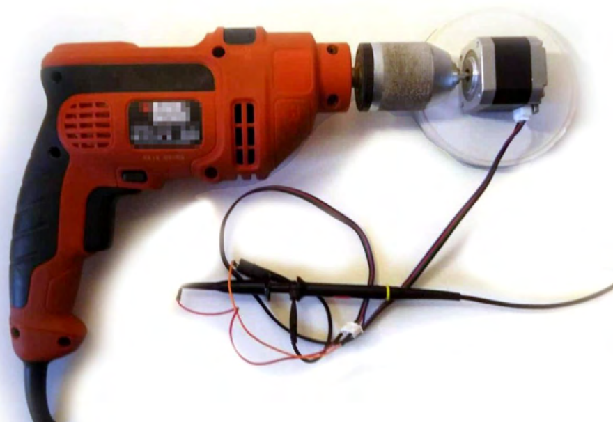
Διάταξη μέτρησης επαγόμενου κύματος με παλμογράφο(Εικ. 3.10)
