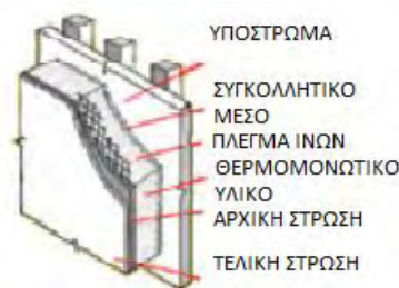
Σχήμα 3.7 Τομή συστήματος εξωτερικής θερμομόνωσης από IAM. (ΣΑΡΔΕΛΗ, 2013)
