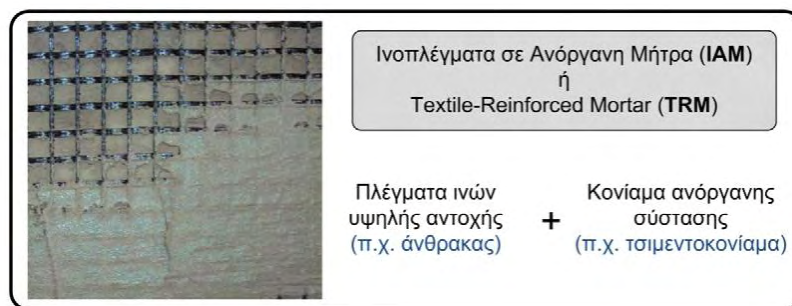
Σχήμα 1.1 Εποπτική περιγραφή του σύνθετου υλικού ενίσχυσης που φέρει την ονομασία Ινοπλέγματα σε Ανόργανη Μήτρα (IAM). (Κούτας, 2015)
