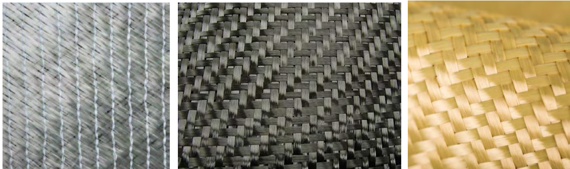
Σχήμα 2.1 Υφάσματα ΙΟΠ συνεχών ινών από (α) υάλου, (β) άνθρακα και (γ) αραμιδίου
