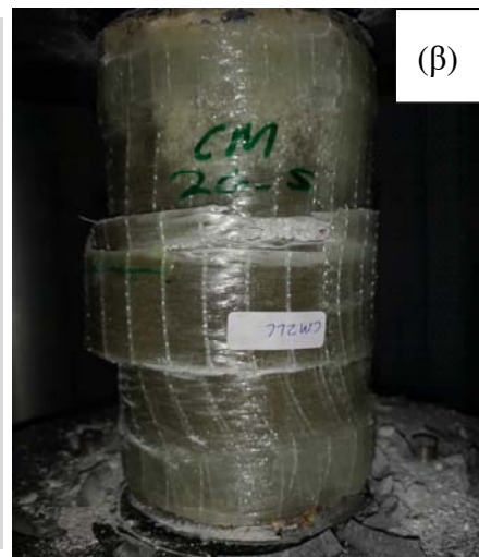
Σχήμα 4.5: (α) Διάγραμμα τάσης – παραμόρφωσης περισφιγμένου με δύο στρώσεις ινοπλισμένου πολυμερούς από ίνες γυαλιού δοκιμίου, ομάδας CM, (β) μορφή αστοχίας περισφιγμένου με δύο στρώσεις ινοπλισμένου πολυμερούς από ίνες γυαλιού δοκιμίου, ομάδας CM σε θλίψη.
