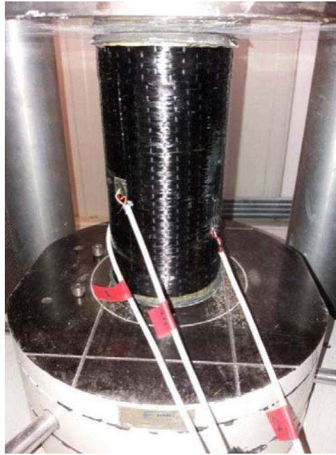
Σχήμα 3.21: Πειραματική διάταξη δοκιμής θλίψης δοκιμίου περισιφισμένου με ίνες άνθρακα
