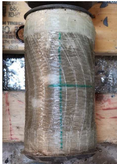
Σχήμα 3.19: Μαρκάρισμα κάθετων ευθειών προκειμένου να τοποθετηθεί το strain gauge στη μέση του δοκιμίου
