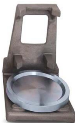
Σχήμα 3.17: Βάση για την επιπέδωση των επιφανειών φόρτισης
