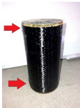
Σχήμα 3.15: Τοποθέτηση πρόσθετων λωρίδων πάχους 2 cm στα άνω και κάτω άκρα
