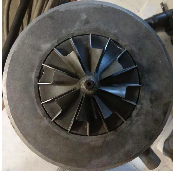
Εικόνα 12 Κάτοψη συμπιεστή μηχανής Detroit Diesel 12V-71TA
