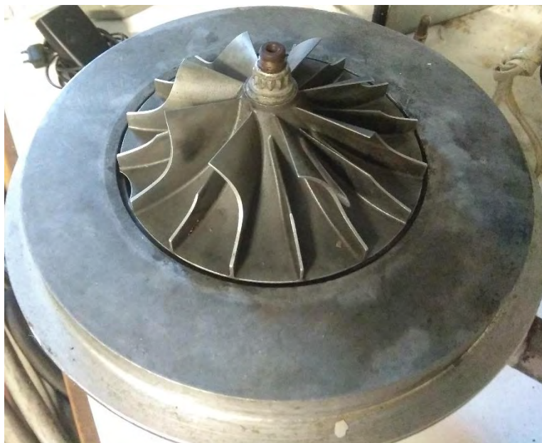
Εικόνα 13 Συμπιεστής μηχανής Detroit Diesel 12V-71TA
