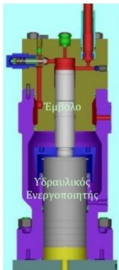
Εικόνα 66 ενισχυτής πίεσης πετρελαίου μηχανής τύπου ΜΕ. (αντλία υψηλής πίεσης)
