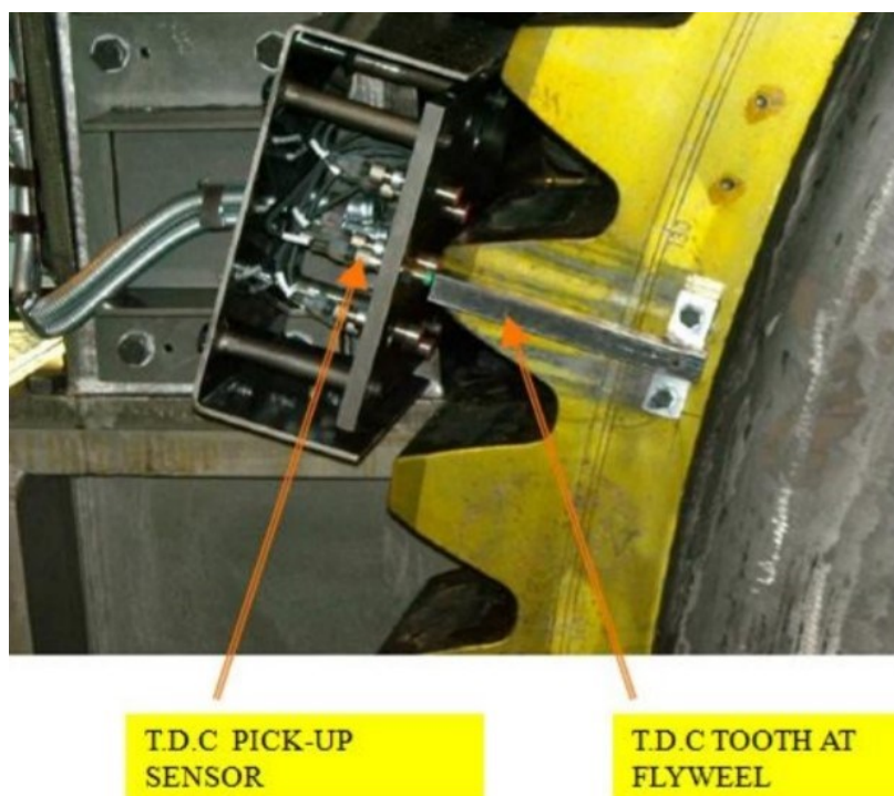
Εικόνα 38 αισθητήρας μέτρησης της ταχύτητας περιστροφής του στροφαλοφόρου
