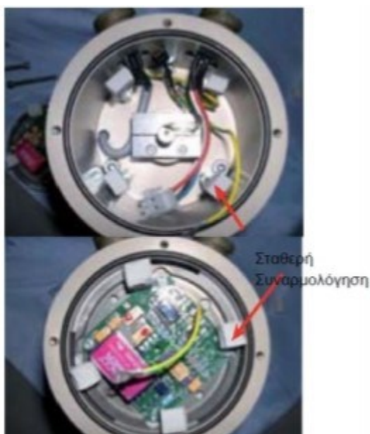
Εικόνα 63 βαλβίδα ELFI, πλακέτα τυπωμένου κυκλώματος ασφαλισμένη με σταθερή συναρμολόγηση.
