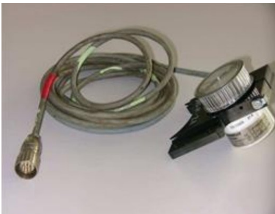
Εικόνα 37 ο αισθητήρας γωνίας στροφάλου με το στήριγμά του και το καλώδιο μετάδοσης ψηφιακού σήματος.
