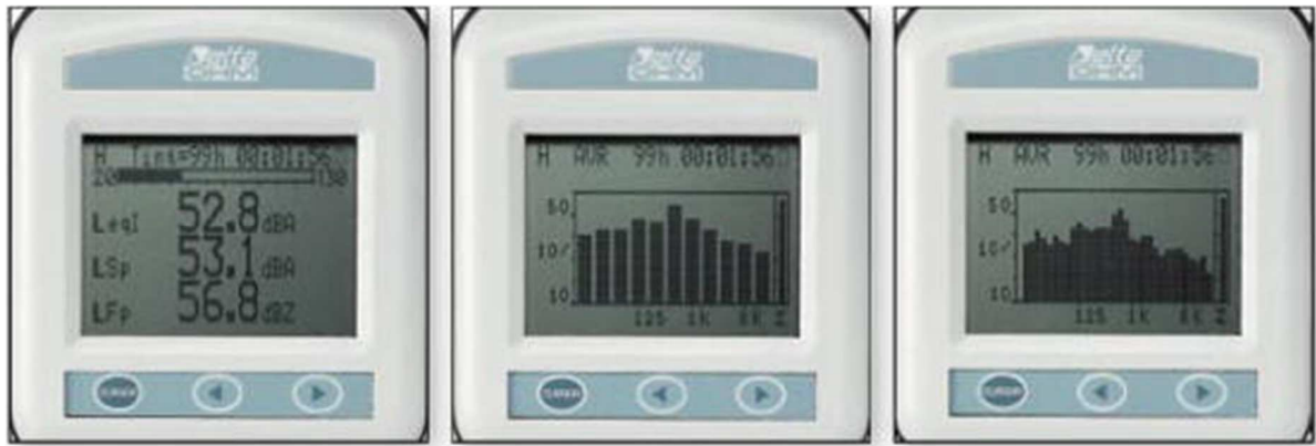
Εικόνα 18. Οθόνη ταυτόχρονων πολλαπλών ενδείξεων των ηχομέτρων που χρησιμοποιήθηκαν στο παρόν όπως φαίνονται παραπάνω: μετρήσεις του ήχου σε dB, σε οκτάβες και τριτοκτάβες. Τέτοιου τύπου ηχομέτρα ονομάζονται στατιστικοί & φασματικοί αναλυτές) Πηγή: (Ηχοπαρέμβαση, 2018)
