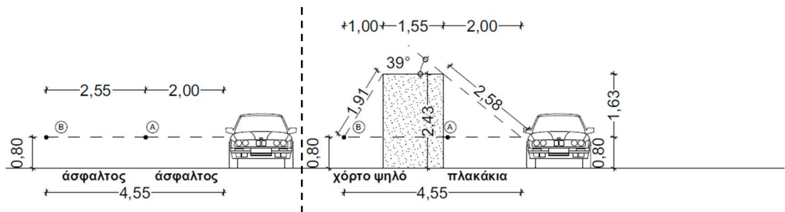
Σχήμα 19. Πειραματική διάταξη για την πραγματοποίηση της 3ης μέτρησης στη Λεύλαντ. Παρατίθενται όλες οι διαστάσεις με την ποιότητα του εδάφους και τη θέση των μικροφώνων με και χωρίς τον ηχοφράκτη.
