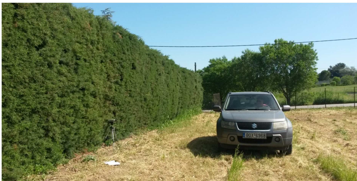
Εικόνα 16. Τυπική τοποθέτηση του ηχόμετρου Α μπροστά από τον φυτοφράκτη και ανάμεσα σε αυτόν και την πηγή θορύβου που είναι το εικονιζόμενο όχημα.
