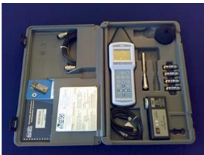
Εικόνα 17. Ένα από τα ηλεκτρονικά ηχόμετρα που χρησιμοποιήθηκαν και ο συνοδευόμενος εξοπλισμός του που περιλαμβάνει συσκευή για βαθμονόμηση και καλώδιο επέκτασης. Πηγή: (Ηχοπαρέμβαση, 2018)
