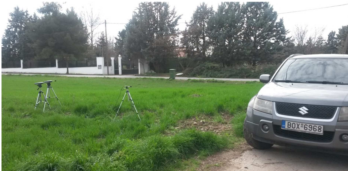
Εικόνα 15. Τυπική τοποθέτηση ηχόμετρων στη δεύτερη σειρά μετρήσεων.
