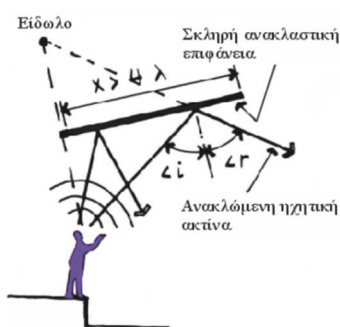
Σχήμα 3. Το ηχητικό φαινόμενο της ανάκλασης όταν το μήκος κύματος είναι τουλάχιστον τέσσερις φορές μεγαλύτερο μίας διάστασης της ανακλαστικής επιφάνειας. Πηγή: (Egan, 1972)
