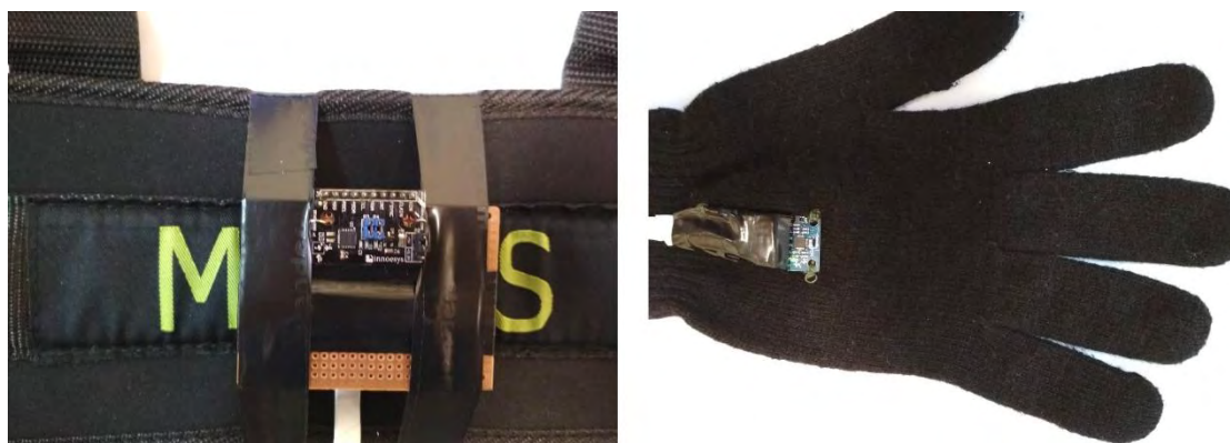
Εικόνα 28: Αισθητήρες MPU-6050 στη ζώνη και στο χέρι.
