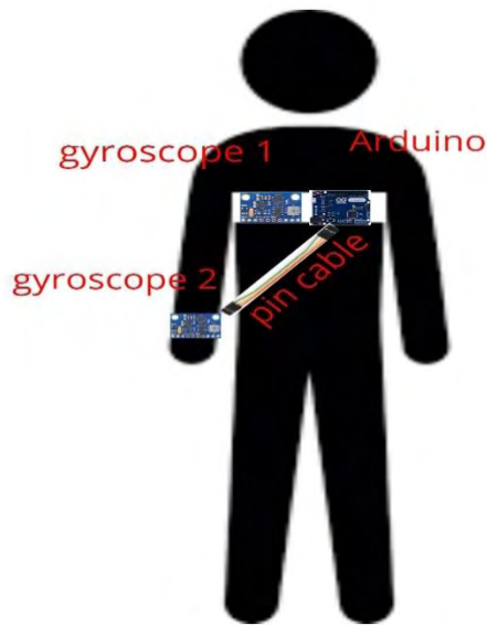
Εικόνα 9: Σημεία τοποθέτησης Gyro MPU πάνω στον χρήστη.
