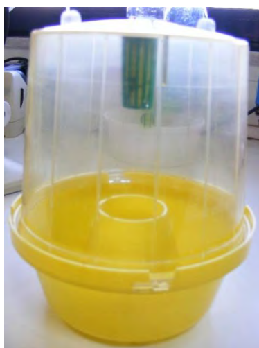
Εικόνα 8. Παγίδα τύπου McPhail της IPS
