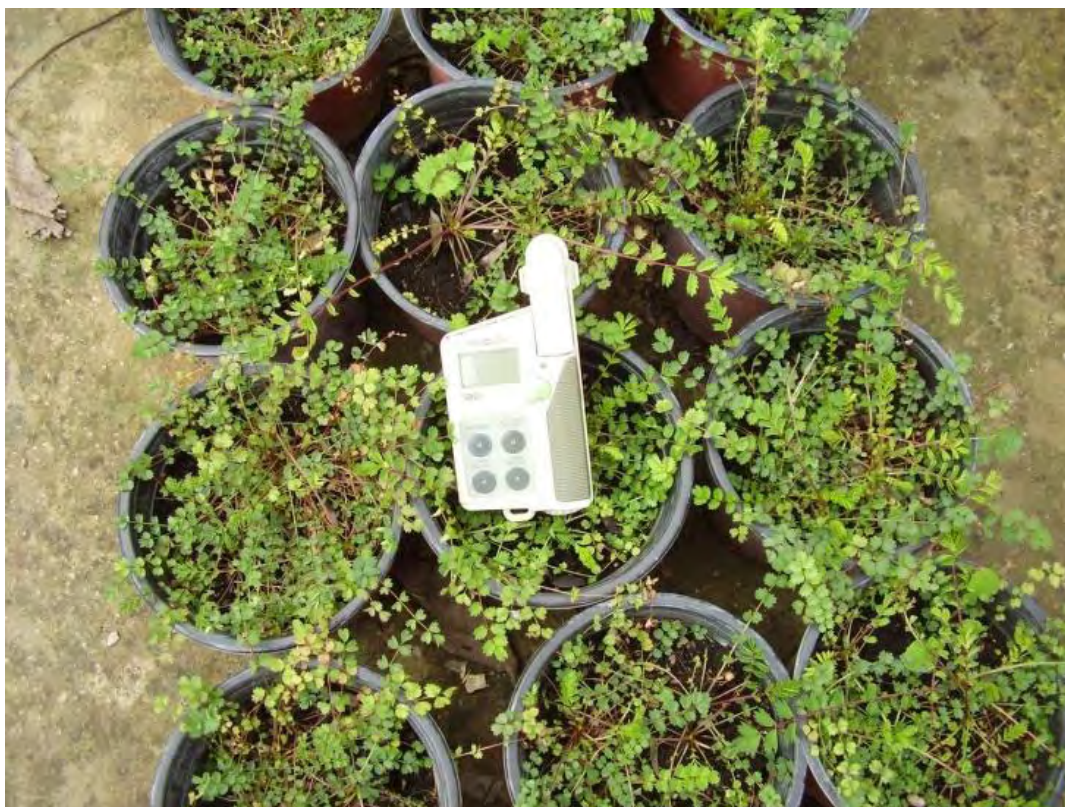
Εικόνα 5. Φορητό όργανο μέτρησης της χλωροφύλλης: SPAD-502 chlorophyll meter (Konica Minolta Optics Inc.).
